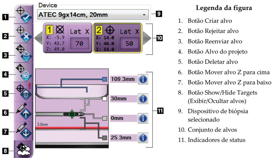
Figura 53: Botões de função e dados da guia Biópsia (Abordagem com agulha lateral)
