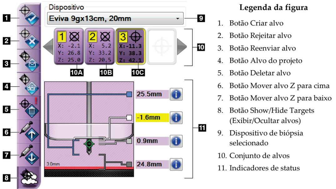
Figura 52: Botões de função e dados da guia Biópsia (Abordagem com agulha padrão)
