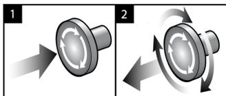
*Figura 20: Funcionalidad de interruptor de apagado de emergencia*
