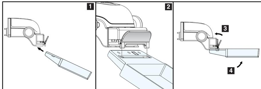
Figura 65: Instalación de la pala de compresión
