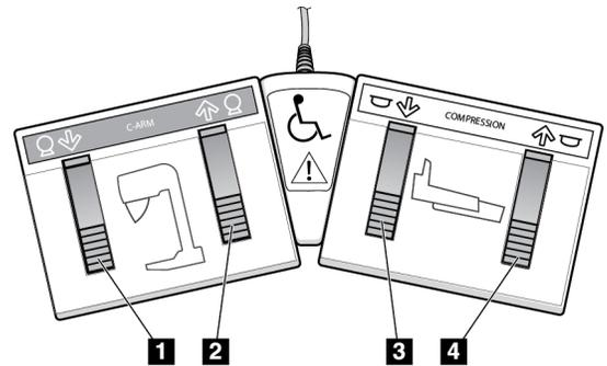
Figura 12: Interruptor de pedal de doble función
