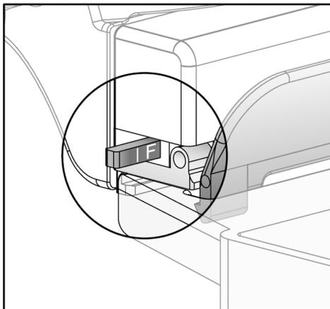
*Figura 67: Control deslizante del modo de compresión FAST*
