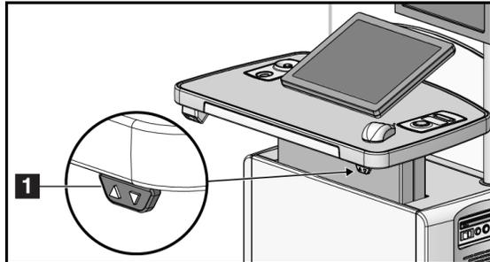
Figura 88: Panel de control de ajuste de altura
