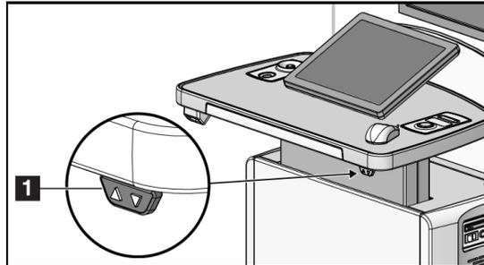
Figura 82: Panel de control de ajuste de altura
