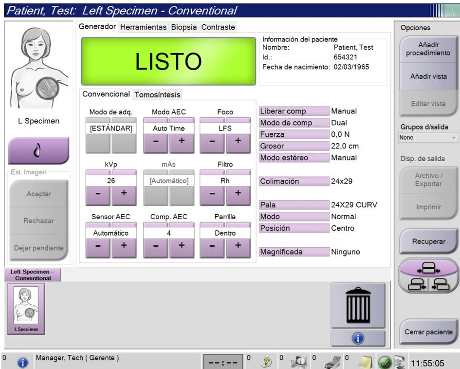
Figura 58: Pantalla de procedimiento para muestras
