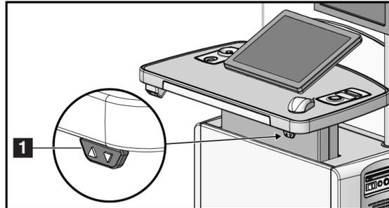
Figura 88: Painel de controle de ajuste de altura
