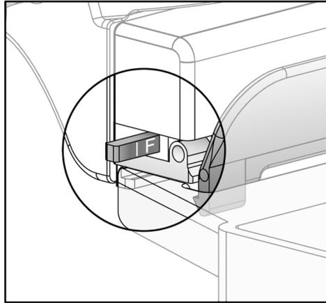
Figura 73: Controle deslizante do modo de compressão FAST
