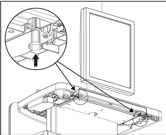
Figura 112: Botão de trava da bandeja do teclado, lado direito ou esquerdo (estação de trabalho de aquisição universal)
