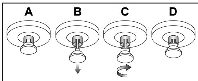
Figura 117: Trava da bandeja liberada de Travada (A) para Destravada (D)
