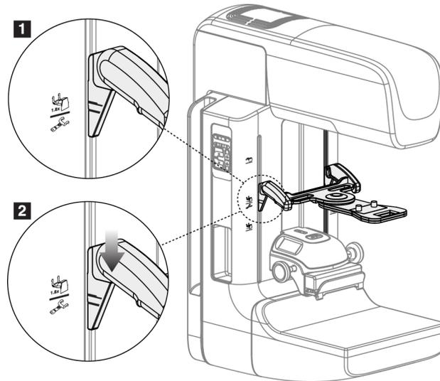
Figura 75: Instalação do dispositivo do retículo de localização
