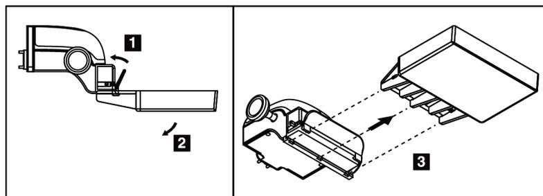
Figura 66: Cómo extraer una pala de compresión
