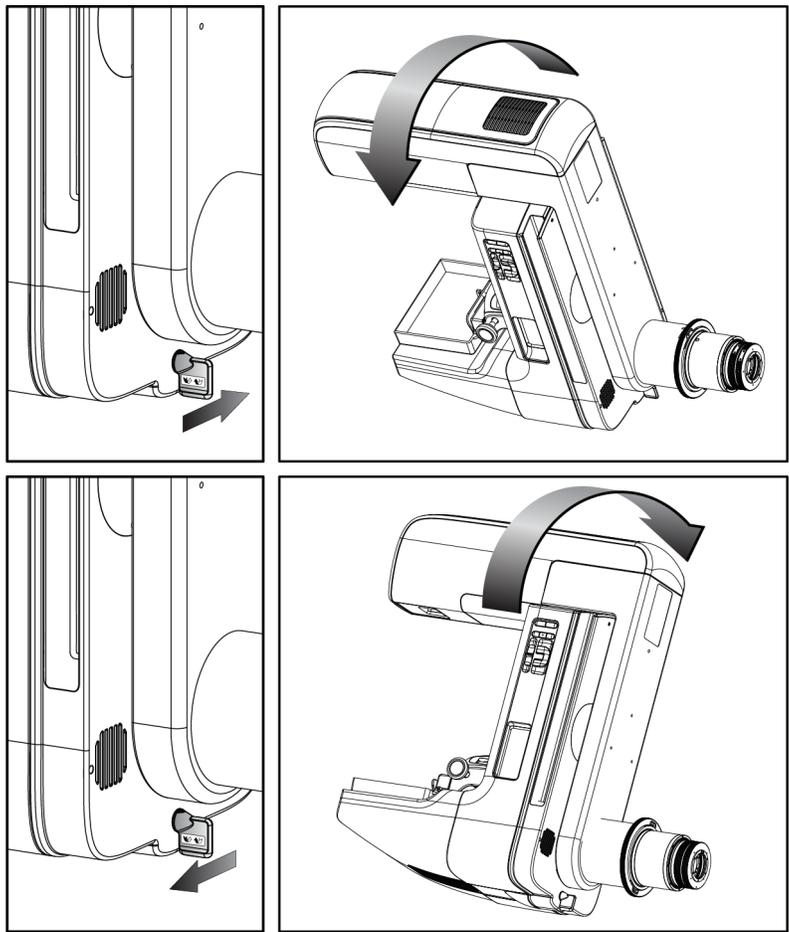
**Rotación automática del brazo del colimador (rotación automática)**
