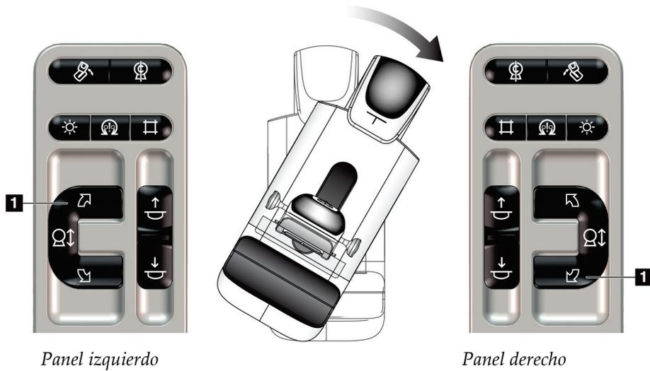
*Tabla 6: Interruptor de rotación del brazo del colimador*
