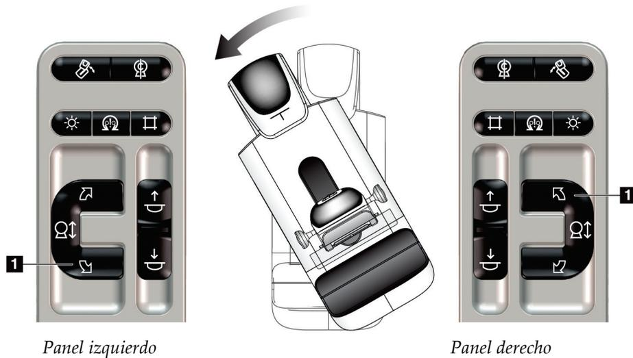
Tabla 5: Rotación del brazo del colimador hacia la derecha
