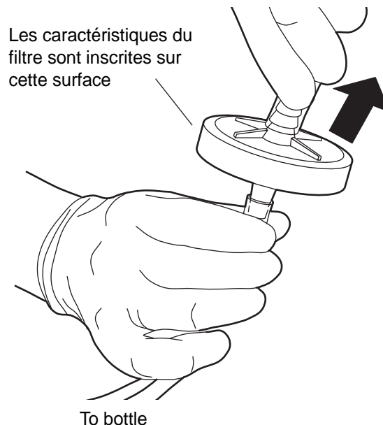
Figure 7-12 Remplacement du filtre à déchets
