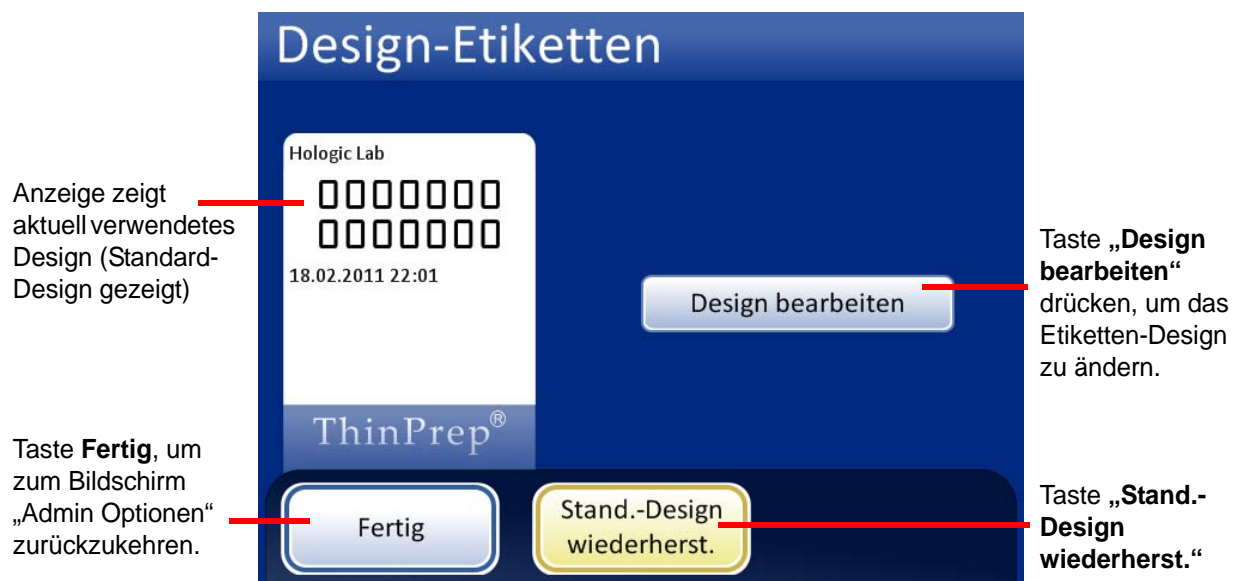
Abb. 6-70 Bildschirm zur Bearbeitung des Etiketten-Designs
