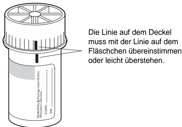
Abb. 3-1 Ausrichten des Fläschchendeckels
