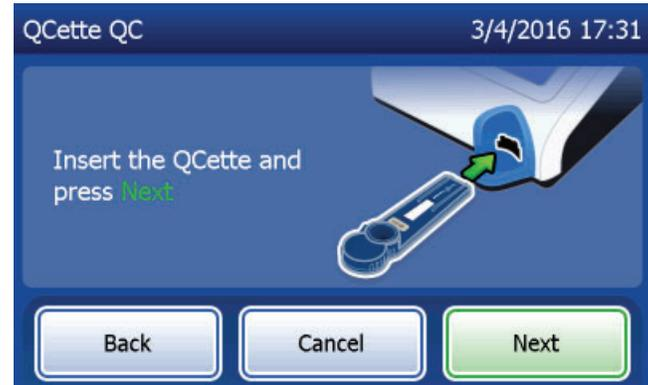
L'analyseur lit la QCette. Ne pas déranger l'analyseur tant que les résultats ne sont pas affichés. L'analyse dure environ 2 à 3 minutes.
