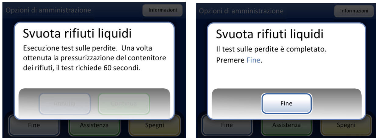
Figura 8-12 Prova di tenuta del sistema di scarico
