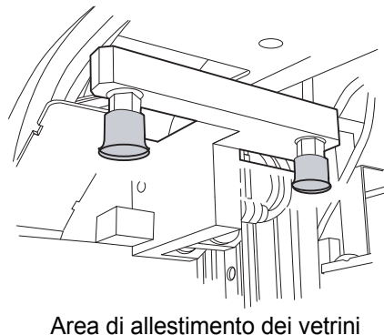
Figura 8-5 Pulizia delle ventose pneumatiche del portavetrini
