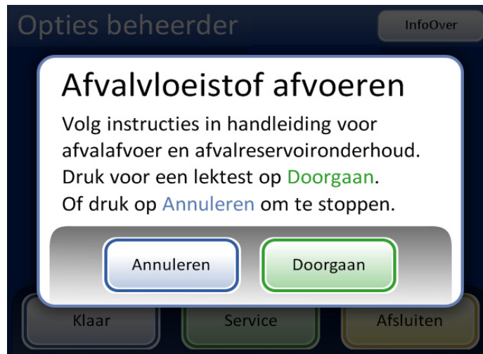
Afbeelding 8-12 De afvalfles legen en onderhoud verrichten
