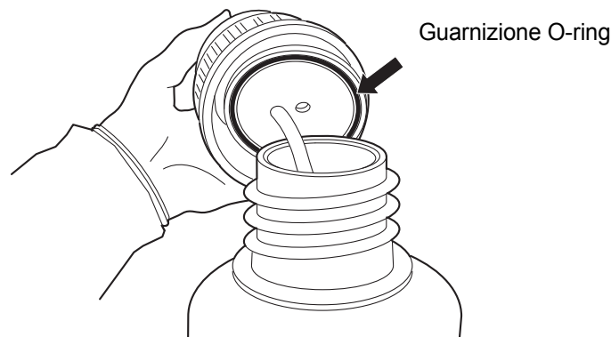
Figura 8-14 Ispezione della guarnizione O-ring della tanica di scarico
