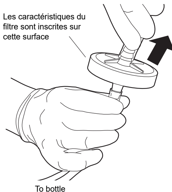
Figure 7-12 Remplacement du filtre à déchets
