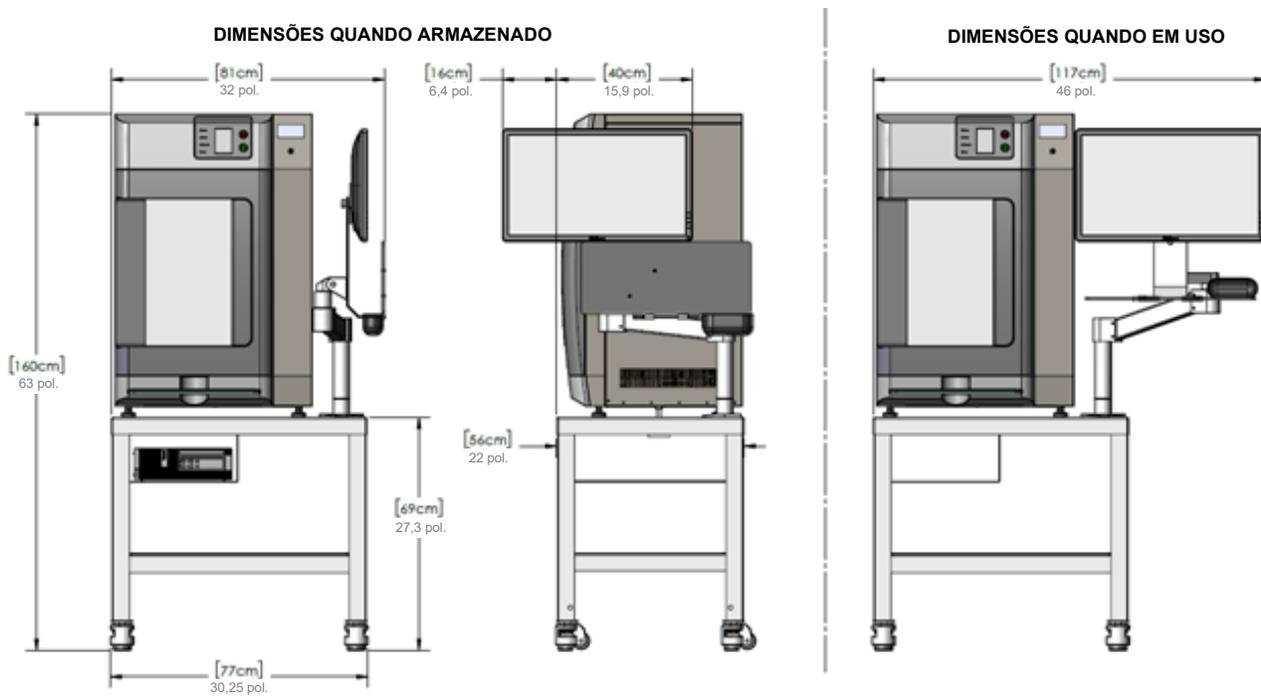
Figura 5: Dimensões do sistema
