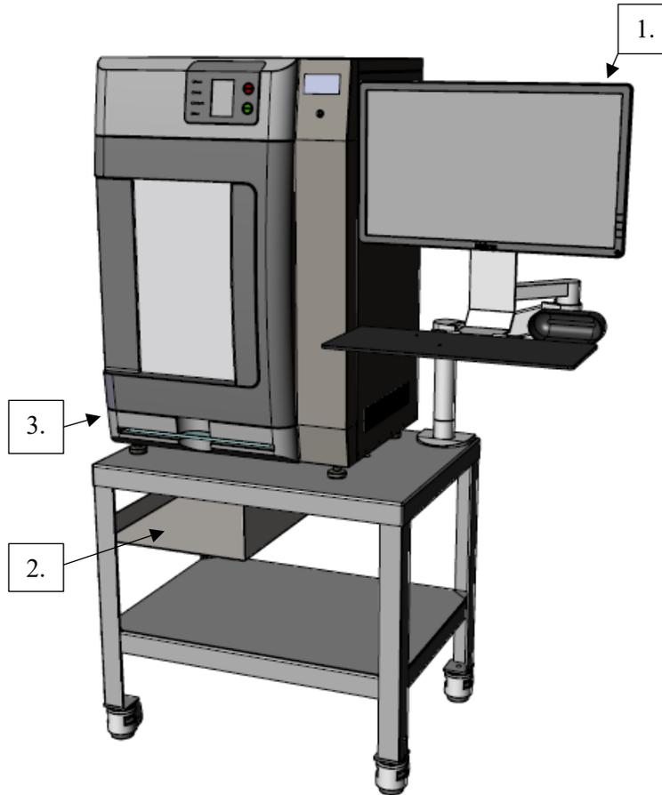
*Figura 1: Mesa y sistema Faxitron Path*
