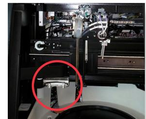
Pinça de lâminas do AutoLoader
