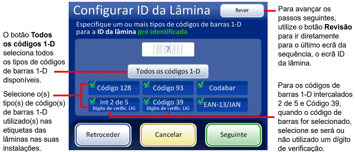
**Figura 6-73** Especifique um ou mais tipos de códigos de barras 1-D para IDs da lâmina pré-identificada
