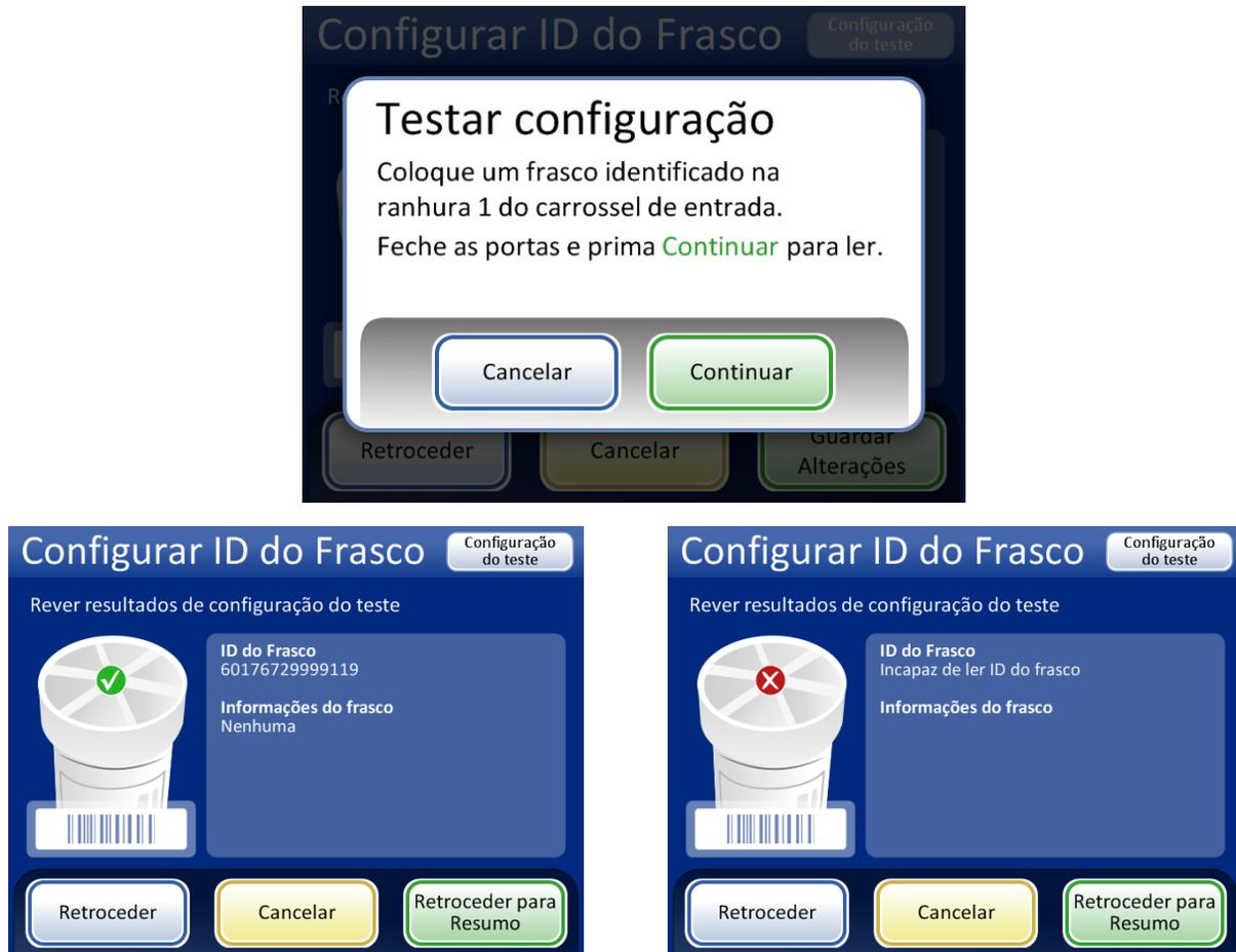
Configuração da ID do frasco bem sucedida. A informação de configuração da ID do frasco corresponde ao rótulo do frasco que foi lido. Neste exemplo, a ID do frasco tem um ID de acesso “60” e existem dois campos adicionais na ID do frasco para além da ID de acesso. Esta configuração corresponde a um frasco identificado com “60|7672999|9” no rótulo do frasco.
