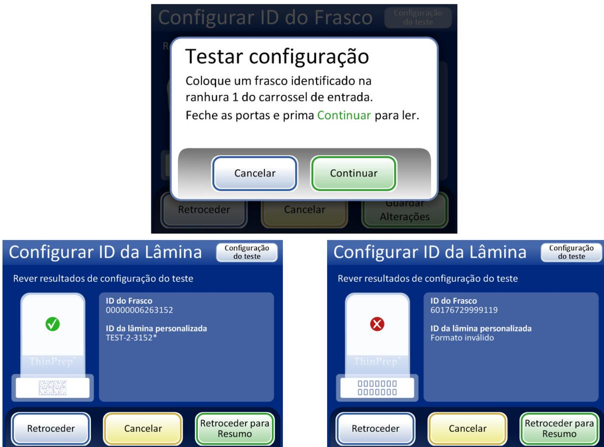
Configuração da ID da lâmina bem sucedida. A informação de configuração da ID do frasco corresponde ao rótulo do frasco que foi lido. A ID da lâmina para a amostra neste frasco seria gravada como "TEST-2-3152\*", neste exemplo, (correspondente às definições de configuração da lâmina impressa a laser mostradas em Figura 6-69.)
