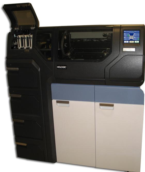
**Figura 2-1** Processador ThinPrep 5000 com AutoLoader típico
