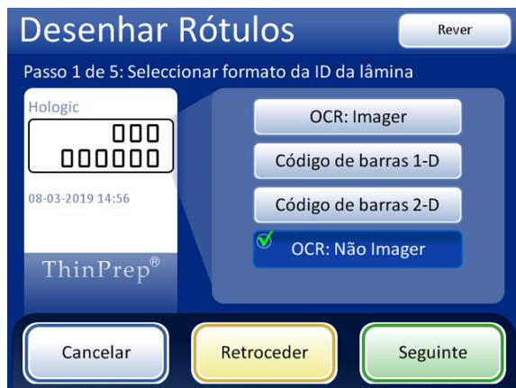
**Figura 6-54 Etapa 1 - Formato de ID da lâmina - OCR: Não Imager**
