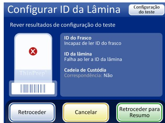
Se a ID do frasco e/ou a ID da lâmina não corresponderem às suas configurações, ou se o segmento especificado da ID da lâmina e da ID do frasco não corresponderem, aparece um “X” vermelho nos resultados da configuração do teste. Corrija as definições de configuração da ID da lâmina e/ou da ID do frasco antes de processar amostras.
