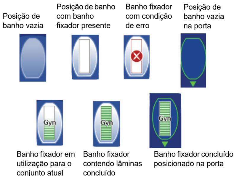
**Figura 6-12 Estado do banho fixador - lâminas ginecológicas como exemplo**
