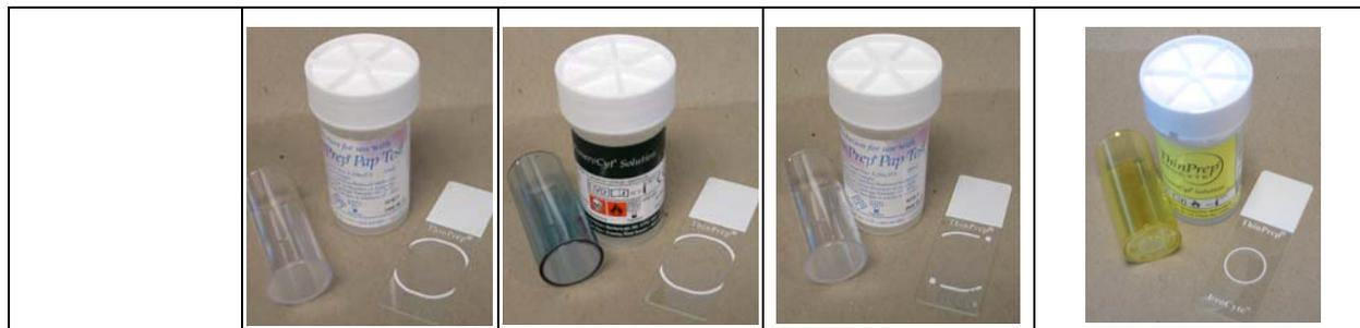
Coloque os frascos etiquetados no carrossel. Coloque a lâmina correspondente na ranhura atrás do frasco. Coloque a lâmina de forma a que a frente (lado do esfregaço de células) fique virada para o exterior. **Segure as lâminas apenas pelas arestas - nunca toque na superfície da área do esfregaço de células.**
