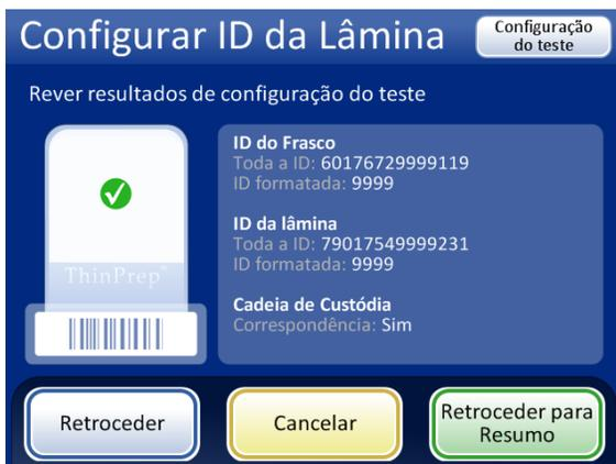
Configuração da ID da lâmina bem-sucedida para lâminas pré-impresas. AID do frasco e a ID da lâmina neste exemplo têm o segmento “9999” em comum, que pode ser configurado como o segmento que começa após a oitava posição e termina após 4 caracteres.
