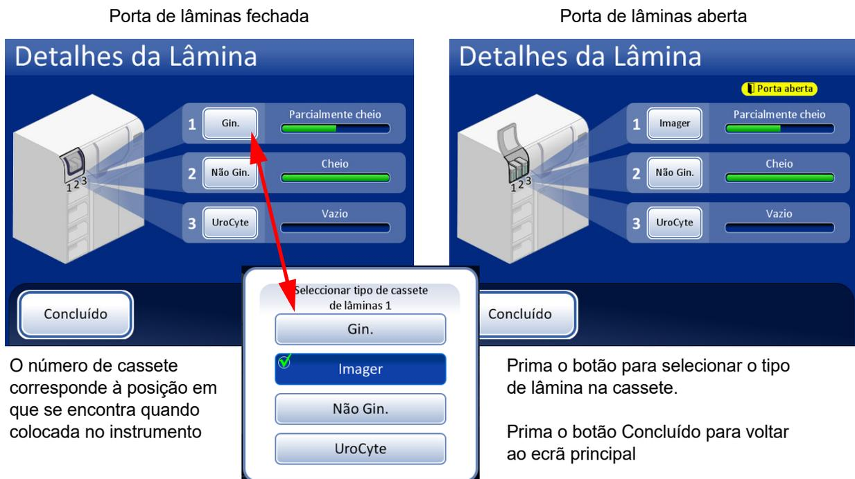
**Figura 6-5 Ecrã Detalhes da lâmina**
