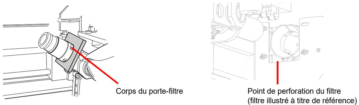
**Figure 8-4 Nettoyer le porte-filtre et de la zone de perforation du filtre**
