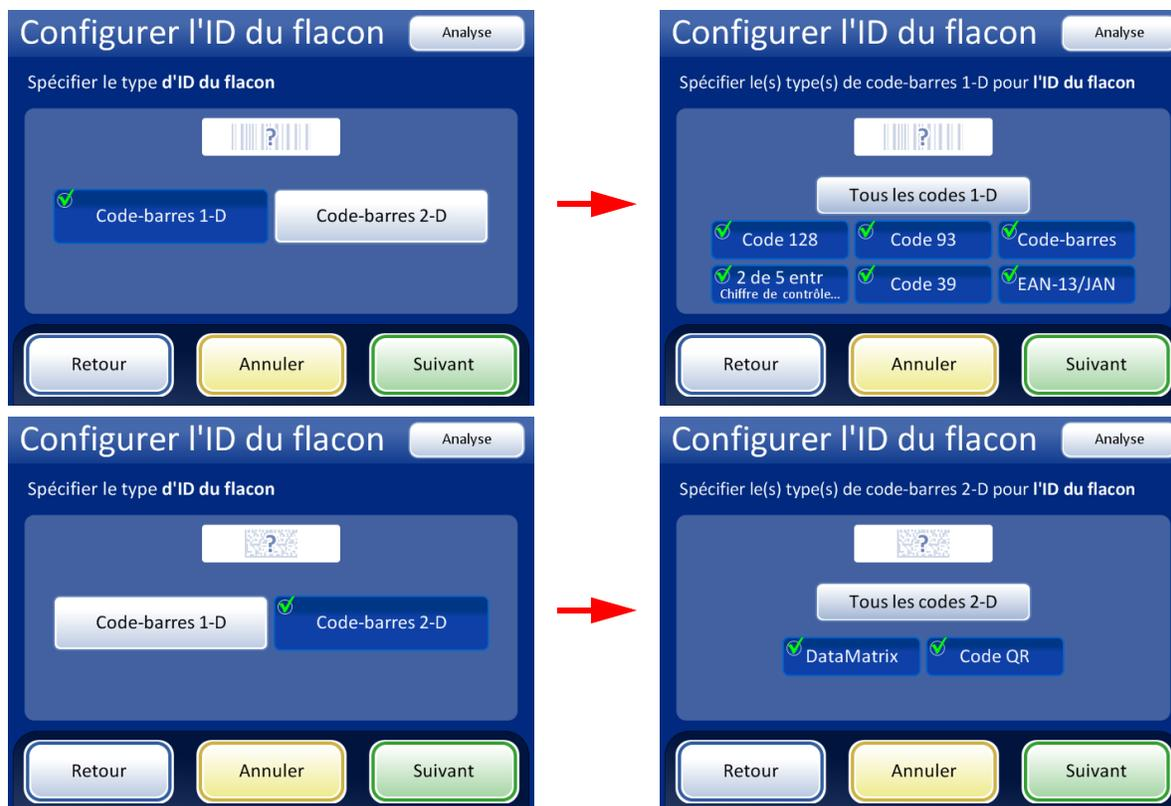
**Figure 6-37 Configuration du (des) type(s) de code-barres d'ID du flacon**
