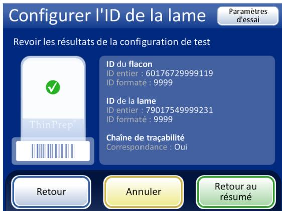
Configuration de l'ID de la lame réussie pour les lames pré-imprimées. L'ID du flacon et l'ID de la lame dans cet exemple ont le segment « 9999 » en commun, qui peut être configuré comme le segment commençant après le huitième emplacement et se terminant après 4 caractères.
