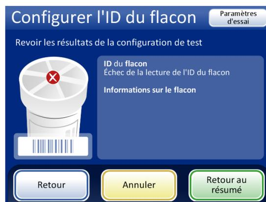
Si l'ID du flacon sur le flacon ne correspond pas aux critères configurés pour l'ID du flacon, l'écran rapporte que l'instrument n'a pas pu lire l'ID du flacon. Corriger l'ID du flacon sur l'étiquette ou corriger la configuration de l'ID du flacon avant de traiter les échantillons.
