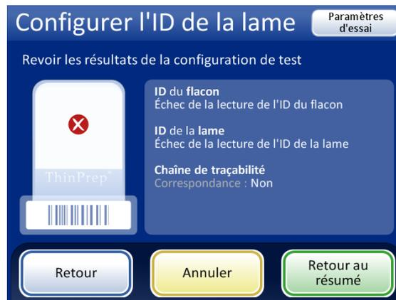
Si l'ID du flacon et/ou l'ID de la lame ne correspondent pas à leurs paramètres de configuration, ou si le segment spécifié de l'ID de la lame et de l'ID du flacon ne correspondent pas, un « x » rouge apparaît dans les résultats de la configuration de test. Corriger les paramètres de configuration de l'ID du flacon et/ou de l'ID de la lame avant de traiter les échantillons.
