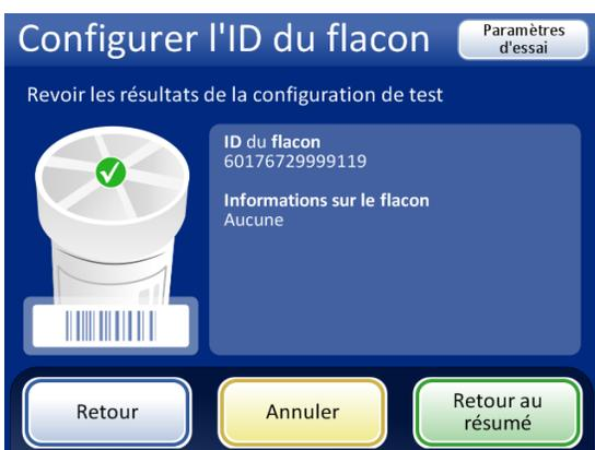
Configuration de l'ID du flacon réussie. Les informations de configuration de l'ID du flacon correspondent à l'étiquette du flacon qui a été numérisée. Dans cet exemple, l'ID du flacon a un identifiant patient de « 60 » et il y a deux champs supplémentaires dans l'ID du flacon en plus de l'identifiant patient. Cette configuration correspond à un flacon imprimé avec « 60|7672999|9 » sur l'étiquette du flacon.
