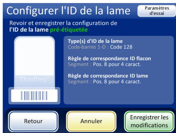
Utiliser le bouton **Paramètres d'essai** pour vérifier la configuration de l'ID du flacon et de l'ID de la lame en numérisant une étiquette de flacon et en numérisant une étiquette de lame correspondante.
