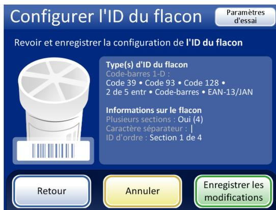
Utiliser le bouton **Paramètres d'essai** pour vérifier la configuration de l'ID du flacon en numérisant une étiquette de flacon
