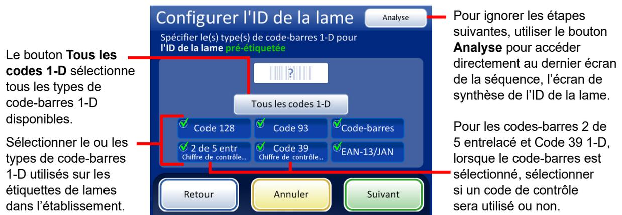
**Figure 6-45 Spécification du (des) type(s) de code-barres 1-D pour les ID de lames pré-étiquetées**
