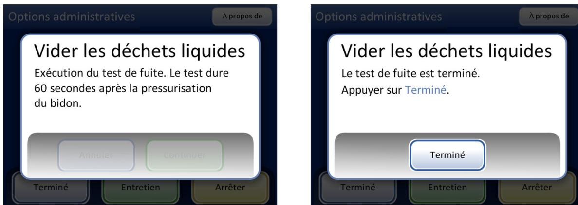
**Figure 8-12 Test de fuite du système d'évacuation des déchets**
