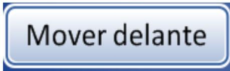
**Mover delante:** para mover un baño fijador a la puerta, toque el botón **Mover delante** con el baño seleccionado o toque dos veces la posición que ocupa en la pantalla. El sistema bloquea la puerta y se mueve hasta la posición que queda delante de la puerta. Cuando la puerta se desbloquea, se puede abrir y extraer el baño fijador.
