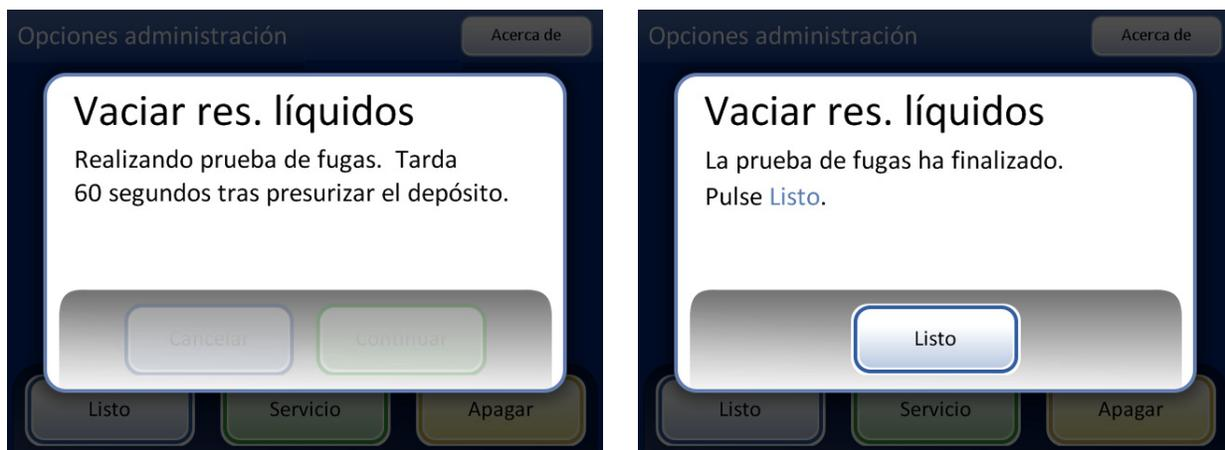
**Figura 8-12 Prueba de fugas del sistema de residuos**
