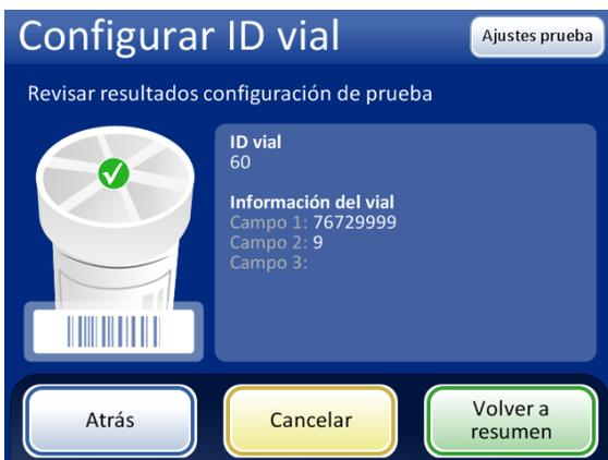
Una configuración correcta del ID de vial. La información de configuración del ID de vial coincide con la etiqueta del vial que se escaneó. En este ejemplo, el ID de vial contiene el ID de acceso "60" y hay dos campos adicionales en el ID de vial además del ID de acceso. Esta configuración coincide con un vial impreso con "60|7672999|9" en la etiqueta del vial.
