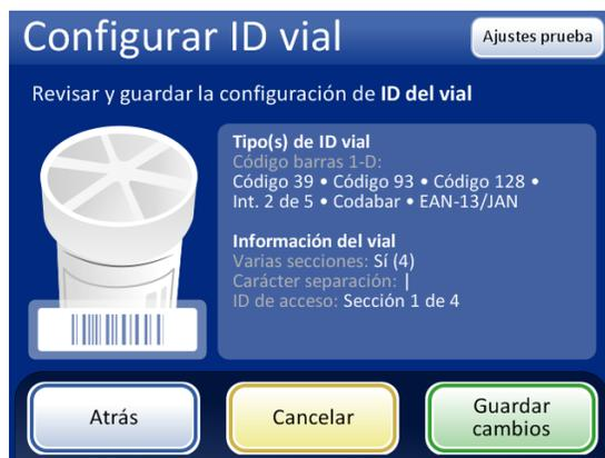
Utilice el botón **Ajustes de prueba** para comprobar la configuración del ID de vial escaneando una etiqueta de vial.
