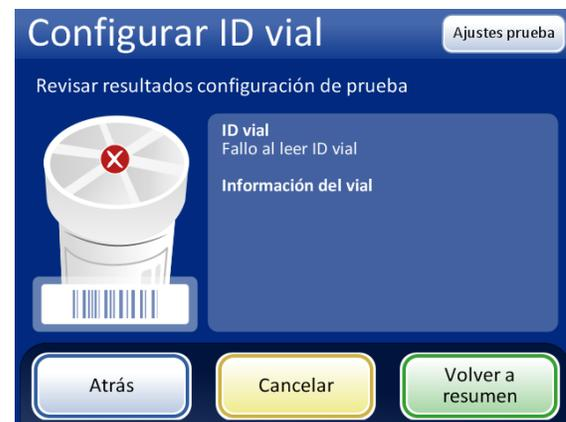
Si el ID de vial en el vial no coincide con los criterios configurados para el ID de vial, en la pantalla se indica que el instrumento no pudo leer el ID de vial. Corrija el ID del vial en la etiqueta o corrija la configuración del ID de vial antes del procesamiento de las muestras.
