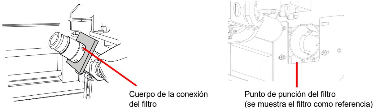
**Figura 8-4 Limpieza de la conexión del filtro y del área de punción del filtro**
