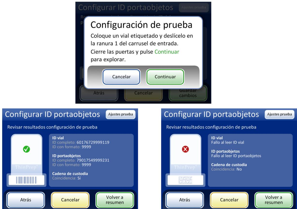
Una configuración correcta del ID de portaobjetos para portaobjetos preimpresos. El ID de vial y el ID de portaobjetos en este ejemplo tienen en común el segmento "9999", que se puede configurar como el segmento que comienza después de la octava posición y termina después de 4 caracteres.
