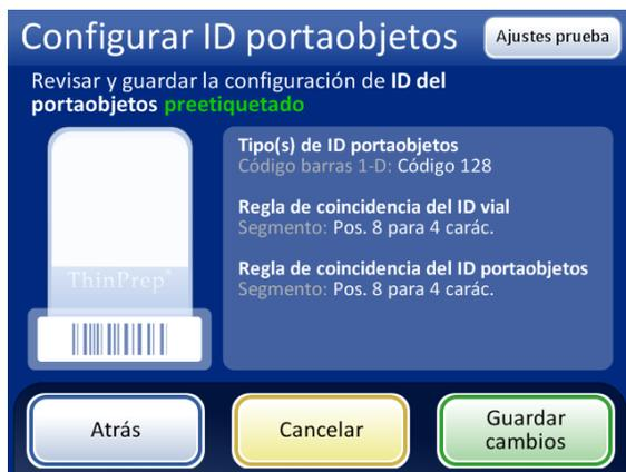
Utilice el botón **Ajustes prueba** para comprobar la configuración del ID de vial y del ID de portaobjetos escaneando una etiqueta de vial y una etiqueta de portaobjetos correspondiente.
