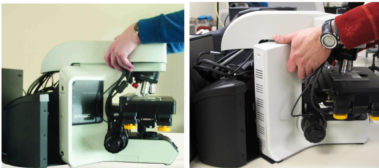
**Figura 2-3 Mover o Integrated Imager (duas configurações de estrutura do microscópio ilustradas)**
