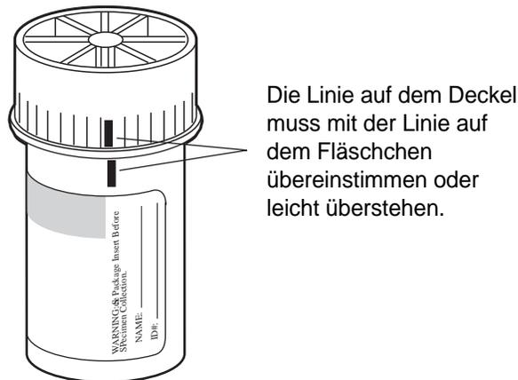
Abb. 3-1 Ausrichten des Fläschchendeckels
