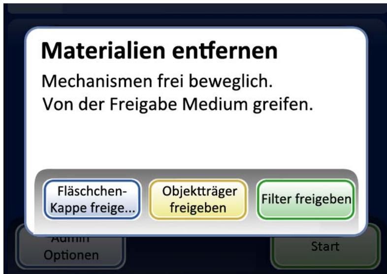
„**Kappe freigeben**“ öffnet die Greifarme des Fläschchengreifers, so dass der Fläschchendeckel abfällt.
