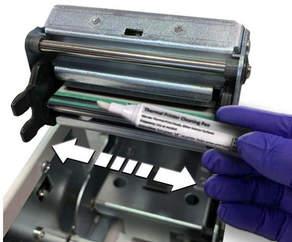
**Figure 8-7 Essuyage du stylo de nettoyage sur la tête d'impression de l'imprimante des lames**
