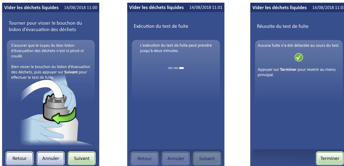
**Figure 8-17 Vissage du bouchon et réalisation du test de fuite du système d'évacuation des déchets**
