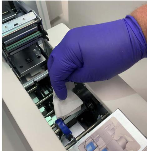
**Figure 8-10 Essuyage des rouleaux de transport de l'imprimante des lames**
