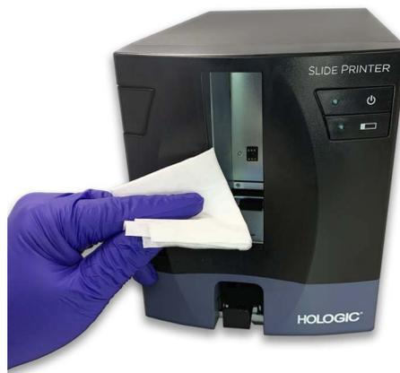
**Figure 8-11 Nettoyage du rouleau d'entrée sur l'imprimante des lames**
