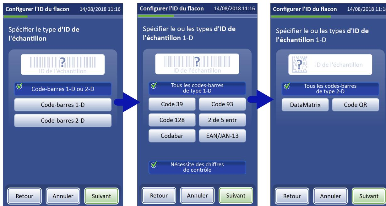
Sélectionner le(s) type(s) d'ID utilisé(s) par le laboratoire sur les flacons d'échantillon, les lames ou les tubes. Appuyer sur **Suivant** pour continuer.
