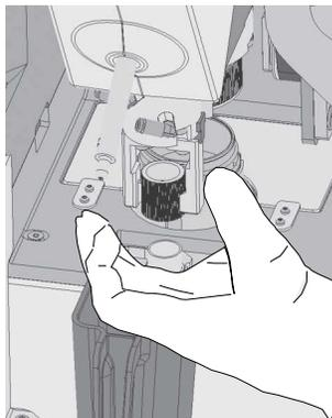
**Figure 9-9 Libération du bouchon du tube**
