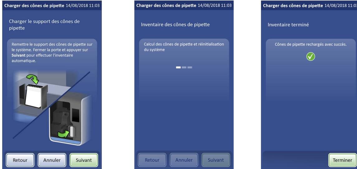
**Figure 7-12 Remise en place du support des cônes de pipette chargé**
