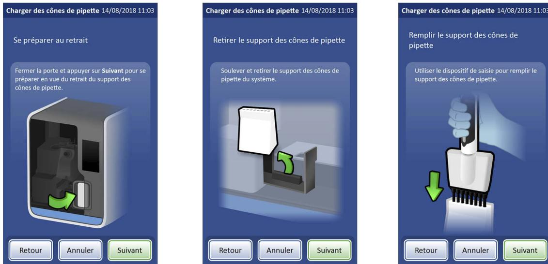
**Figure 7-11 Charger les cônes de pipette dans le support des cônes de pipette**
