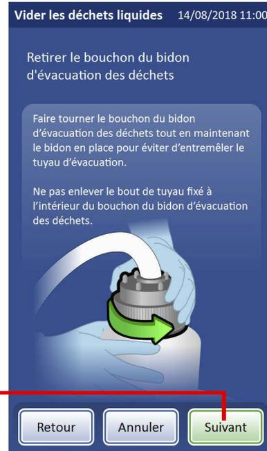
**Figure 8-14 Ouverture/Fermeture du bidon d'évacuation des déchets**
