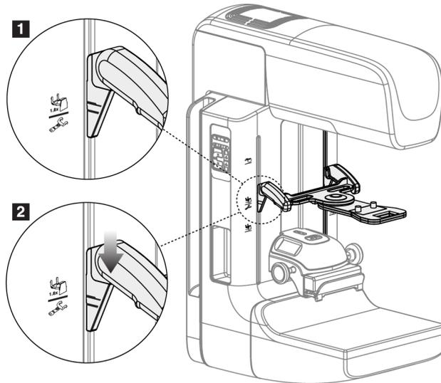
Figure 72 : Installation du dispositif réticulaire de localisation
