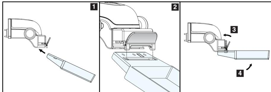
Figure 68 : Pour installer une pelote de compression
