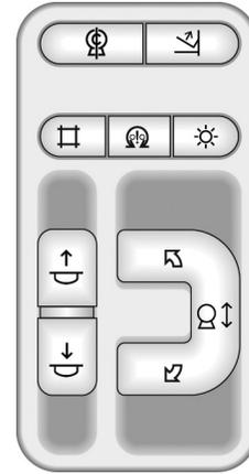
Figure 11 : Panneau de commande du bras en C
