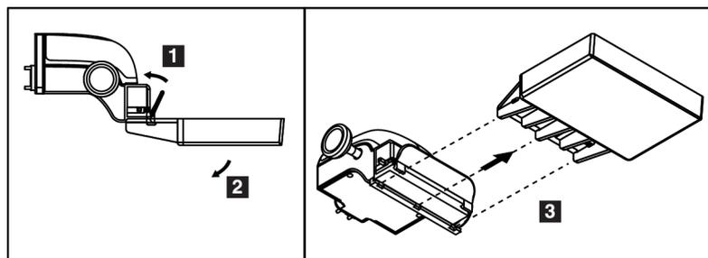
Figure 69 : Pour retirer une pelote de compression
