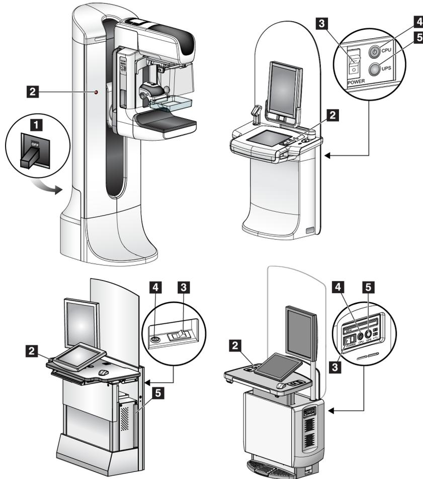
Figure 6 : Commandes d'alimentation électrique du système
