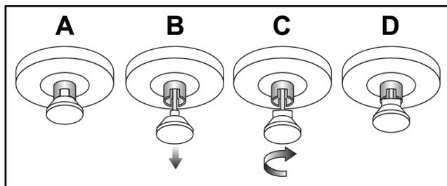
Figure 111 : Dégagement du plateau de la position verrouillée (A) en position déverrouillée (D)
