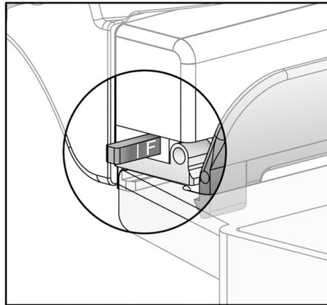
*Figure 70 : Bouton coulissant du mode de compression FAST*
