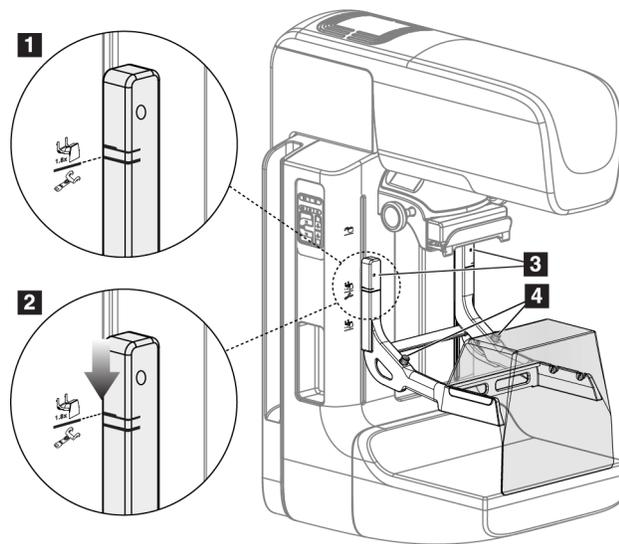
Figure 71 : Installation de la plaque d'agrandissement
