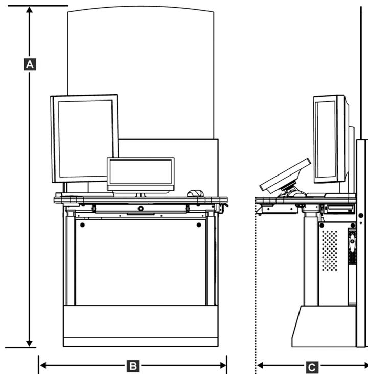
Figura 105: Medidas da Estação de trabalho Acquisition Padrão
