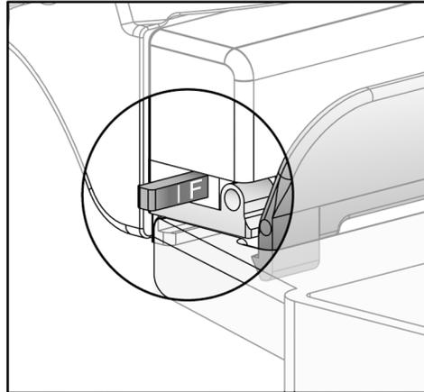
Figura 70: Controle deslizante do modo de compressão FAST
