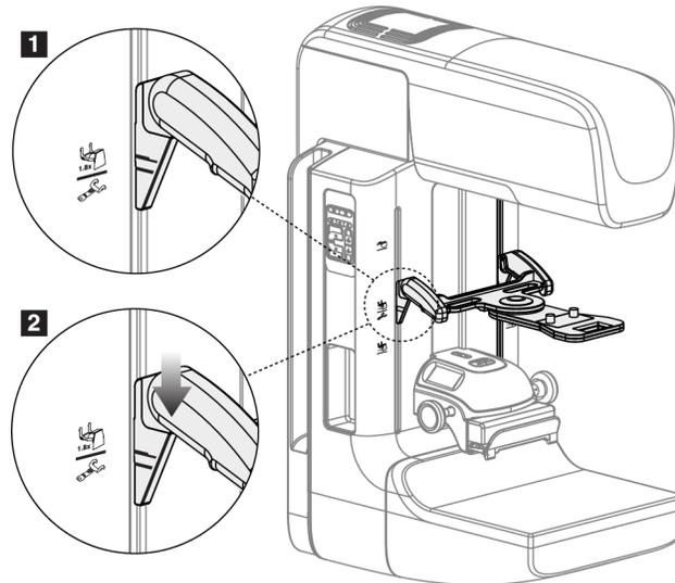
Figura 72: Instalação do dispositivo do retículo de localização
