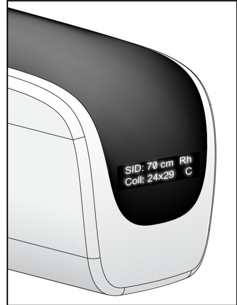
Figura 8: Monitor da cabeça do tubo
