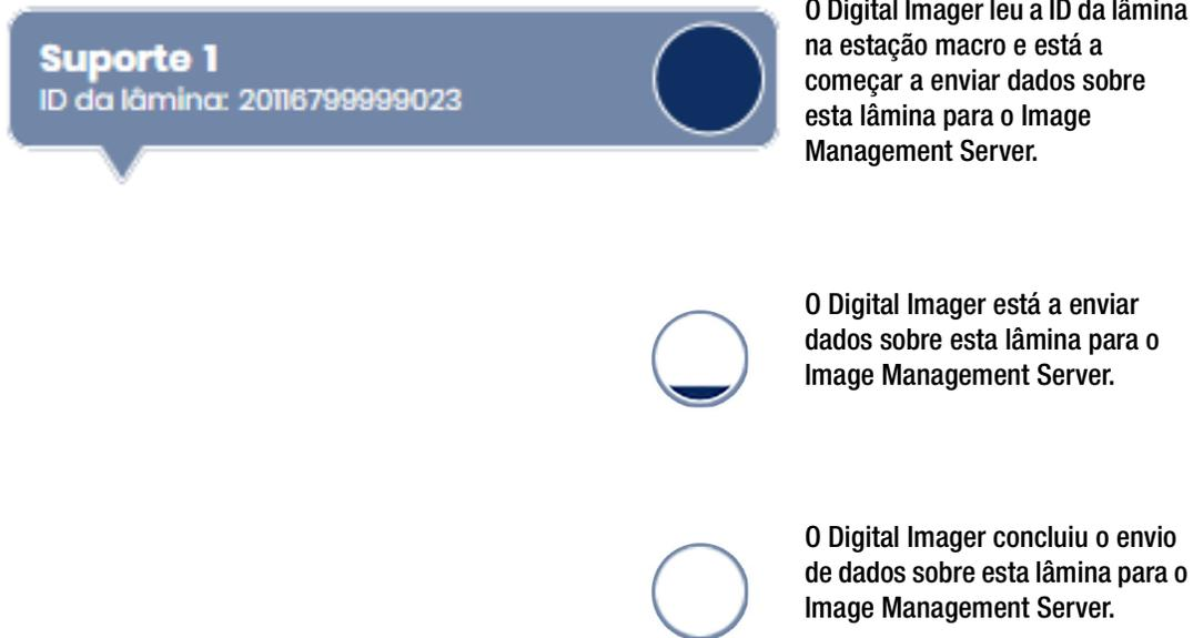
**Figura 3-5 Estado da transmissão de dados das lâminas**
