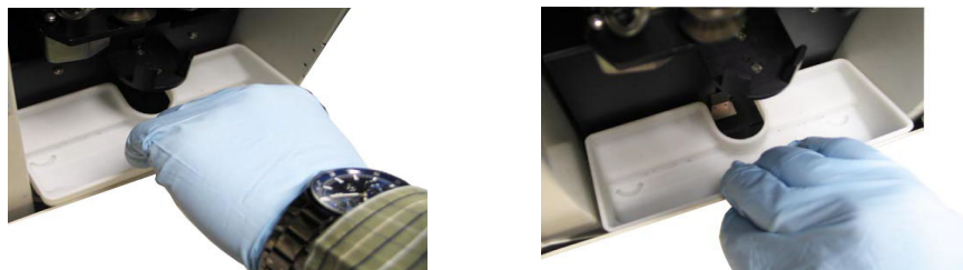
Abbildung 7-13 Auffangschale in den Schrank einsetzen. Schale so einsetzen, dass sich die Schrauben in den Einbuchtungen befinden.
