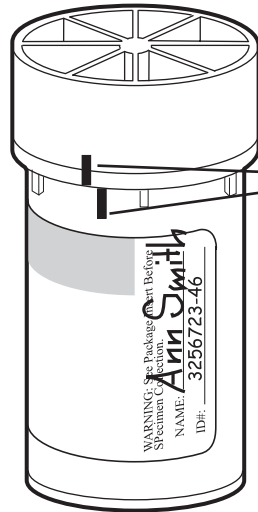
Abbildung 5A-14 Verschließen des PreservCyt-Probenfläschchens
