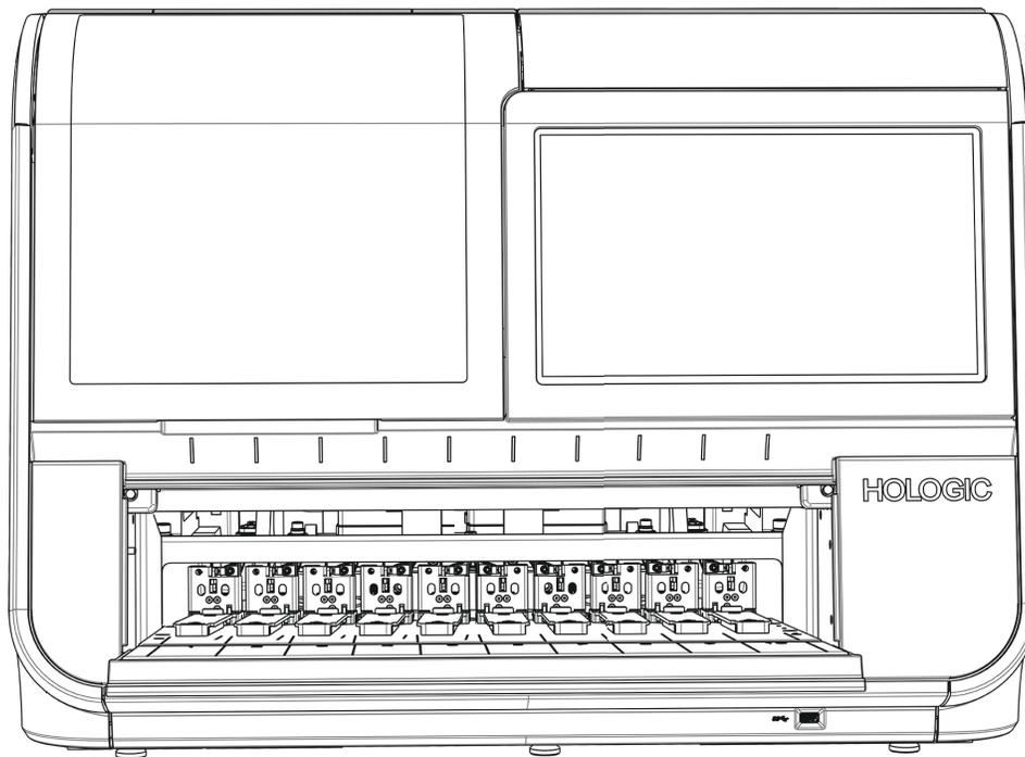
**Figura 5-6 Retire los portadores de portaobjetos para limpiar la plataforma del portador de portaobjetos**
