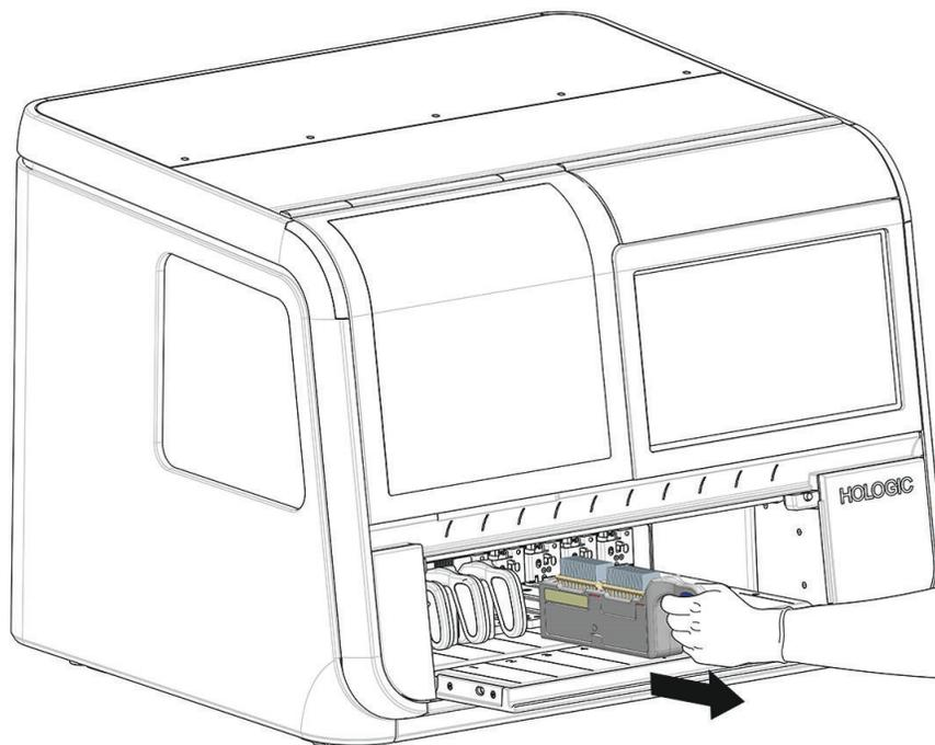
**Figura 4-16 Retire el portador de portaobjetos del generador de imágenes digitales**
