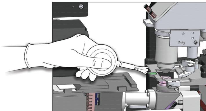
**Figura 5-7 Limpieza del chip de verificación**
