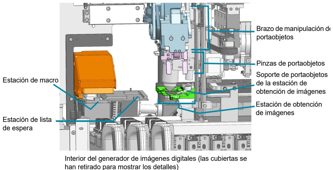
**Figura 5-5 Estación de macro, estación de lista de espera, estación de obtención de imágenes y pinza de portaobjetos**
