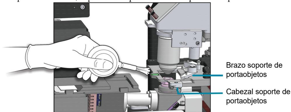
**Figura 5-8 Limpieza del soporte de portaobjetos de la estación de obtención de imágenes**
