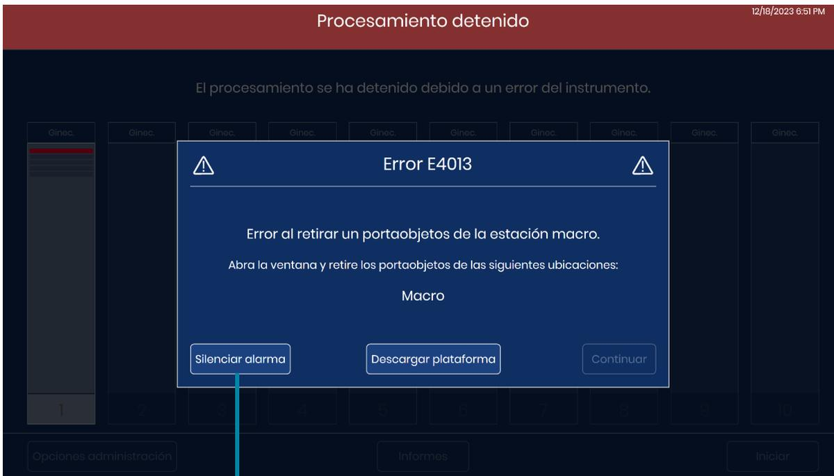
Pulse el botón **Silenciar alarma** para desactivar la alarma dejando el mensaje de error en la pantalla.
