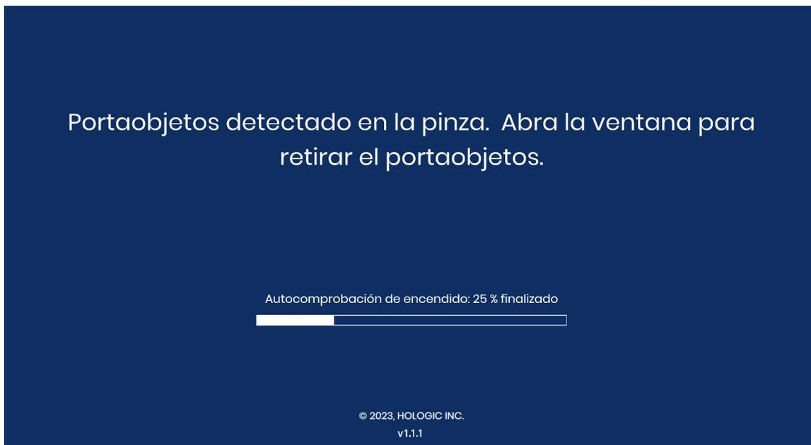
**Figura 6-7 Recuperación de errores con ayuda del usuario: abrir ventana para retirar el portaobjetos**
