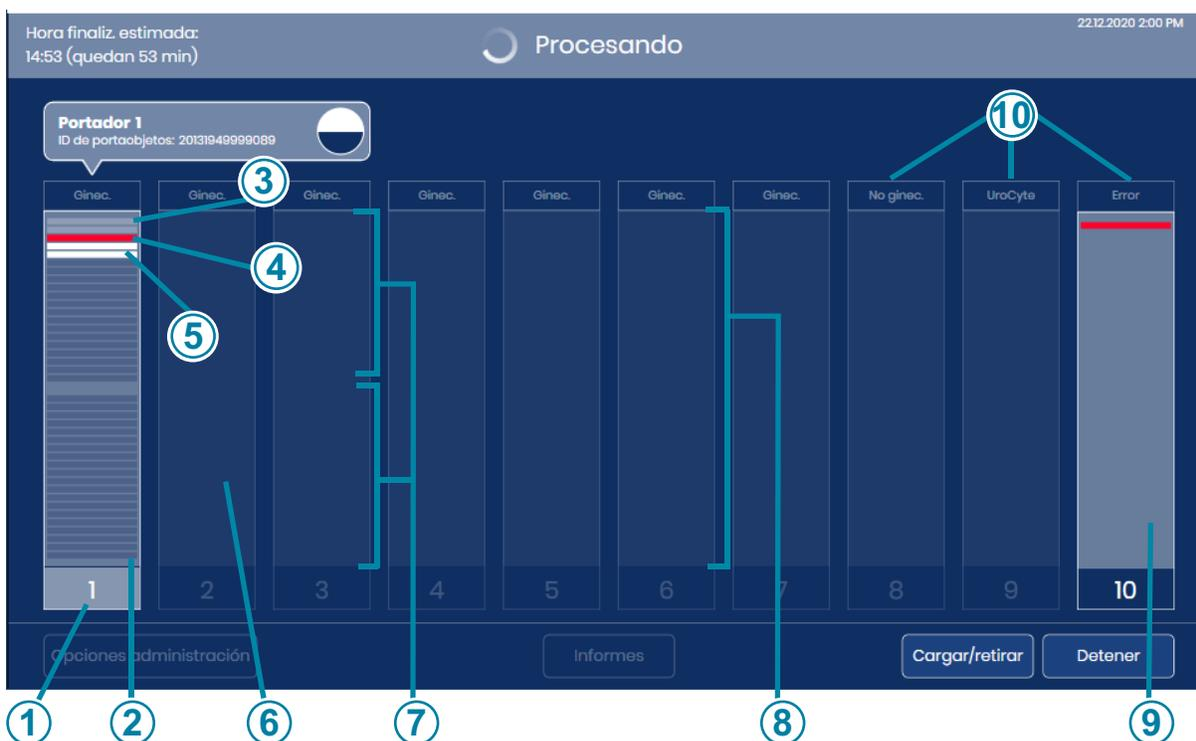
**Figura 3-3** La pantalla de visualización indica la posición del portador de portaobjetos
