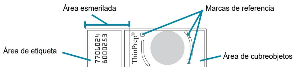
**Figura 6-11** Portaobjetos del Sistema de análisis por imagen ThinPrep para muestras Ginec.
