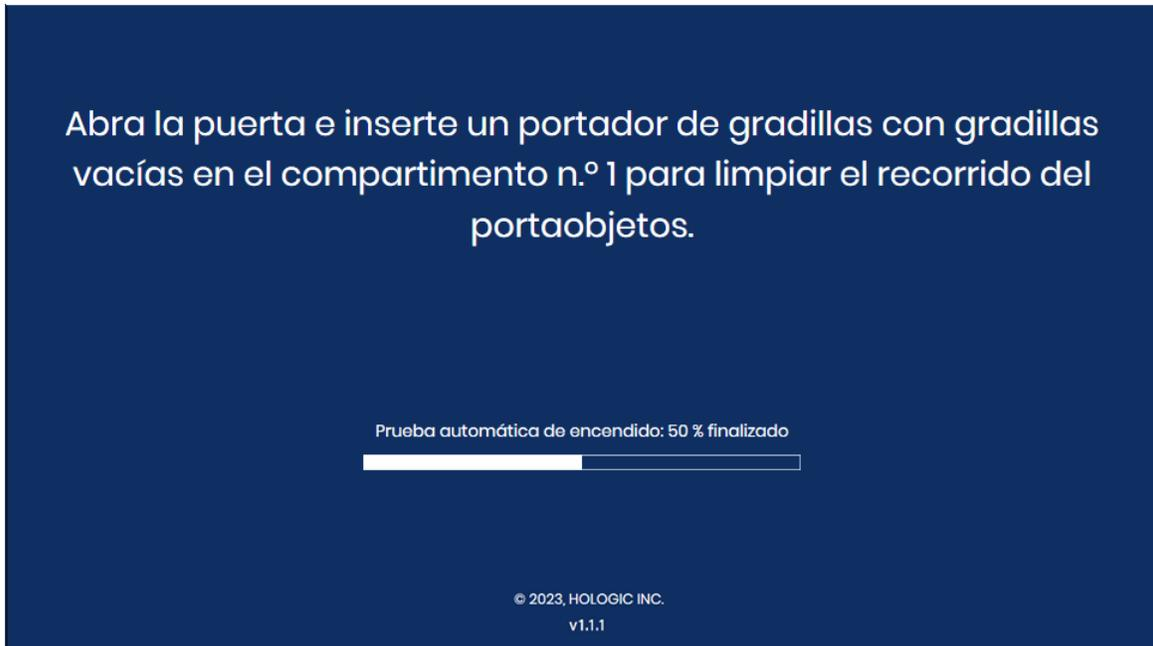
**Figura 6-6 Recuperación de errores con ayuda del usuario: cargar un portador de portaobjetos vacío**
