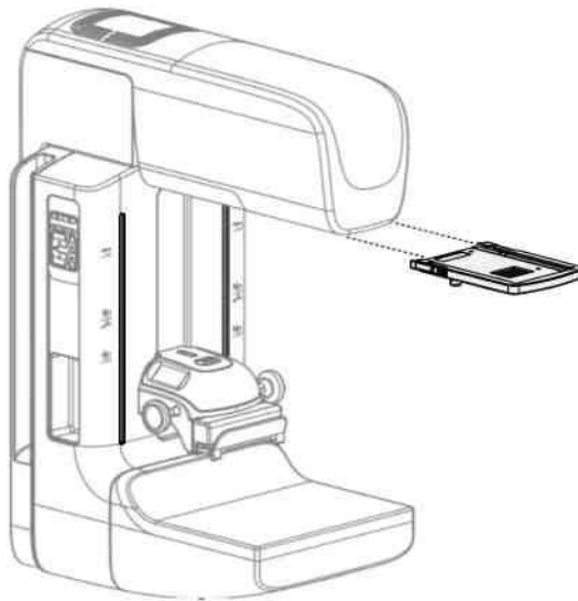
图 6021：如何安装和拆除放大十字准线装置
