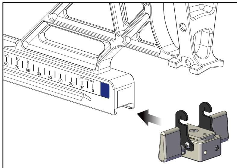
Figura 29: Instalação do X-Stop no braço lateral
