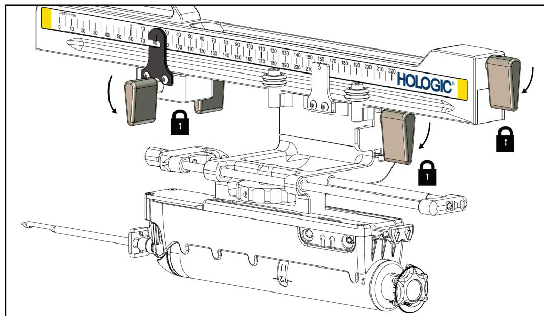
Figura 27: Alavancas de travamento na posição totalmente travada
