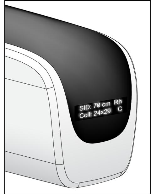
Figura 8: Visor na cabeça do tubo
