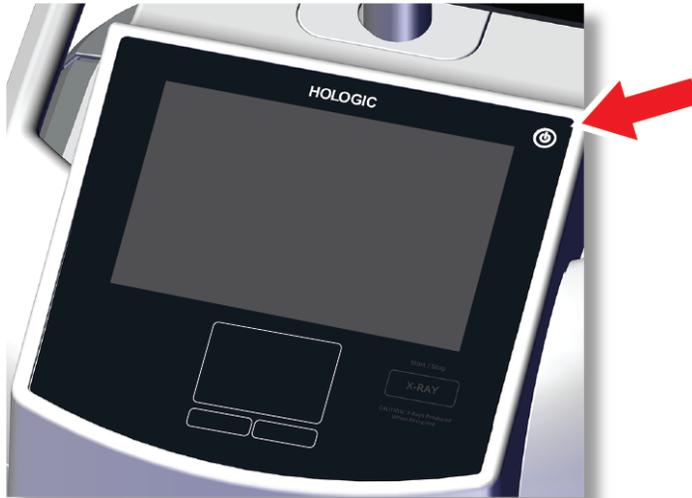
Figura 8: Interruptor de energia do computador
