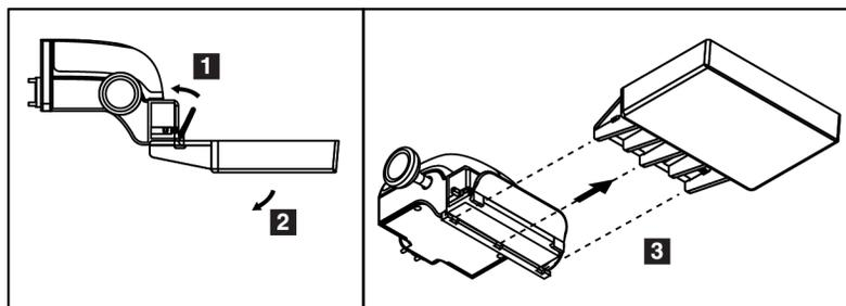
Figura 73: Como remover um compressor de compressão
