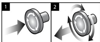
Figura 4: Funcionalidade do interruptor de paragem de emergência
