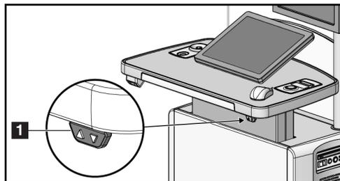
Figura 93: Painel de controlo de ajuste da altura
