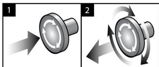
Figura 23: Funcionalidade do interruptor de paragem de emergência
