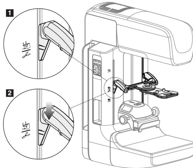
Figura 76: Instalação do dispositivo de mira de localização
