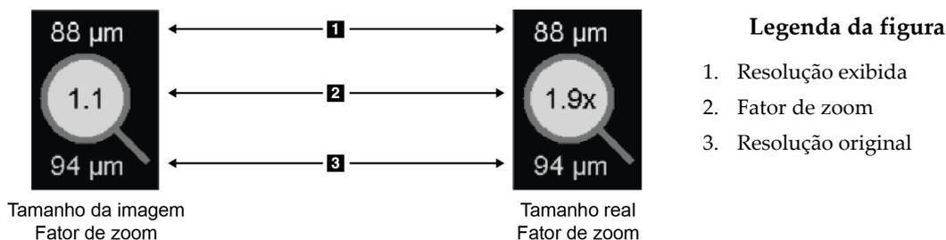
*Medidor de pixel com fundo branco indicando os valores de pixel interpolados*
