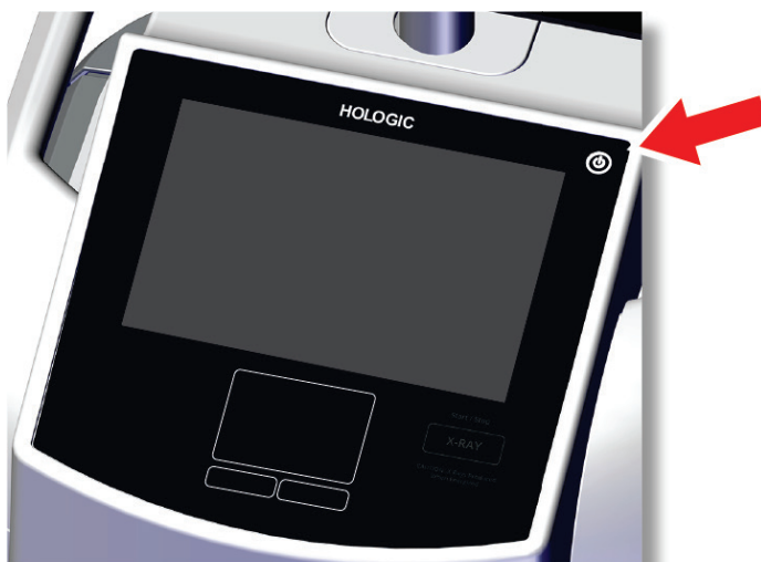
Obrázek 8: Vypínač napájení počítače
