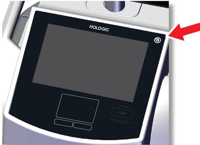
Figura 8: Interruttore di alimentazione del computer
