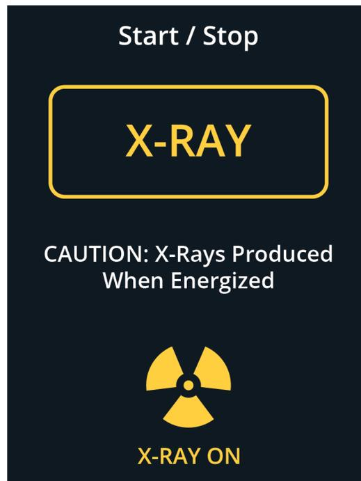
Figure 27 : Bouton X-RAY (RAYONS X) lorsque l'exposition est en cours
