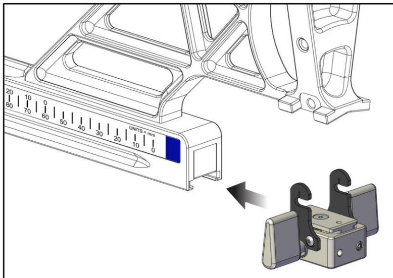
Figura 29: Installazione dell'indicatore X-Stop sul braccio laterale
