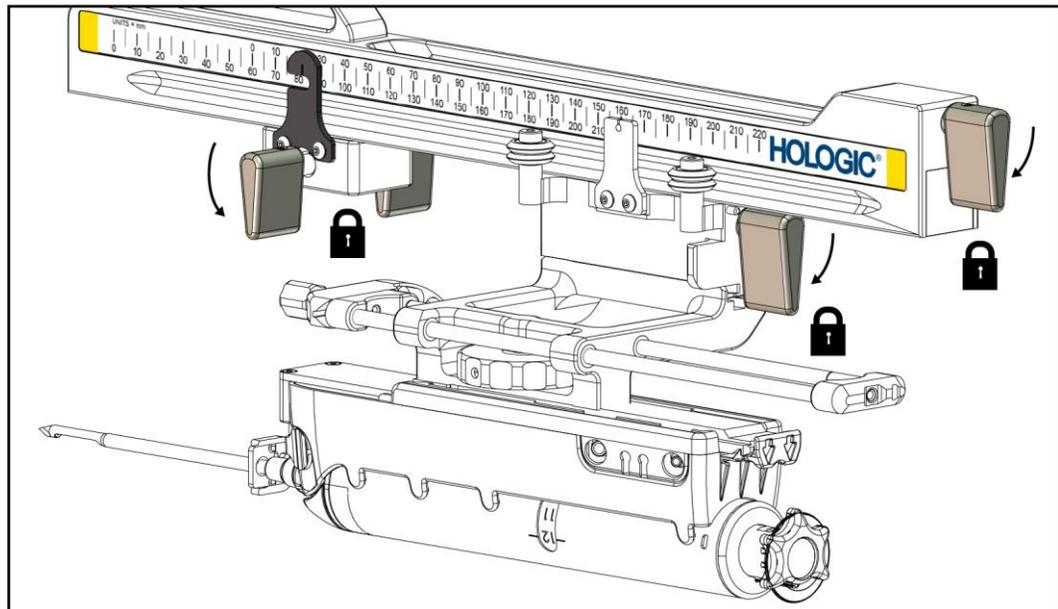
Figura 27: Leve di bloccaggio in posizione completamente bloccata
