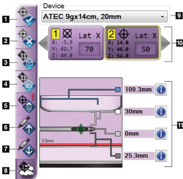
Figura 54: Botones de funciones y datos en la pestaña Biopsia (abordaje de aguja lateral)
