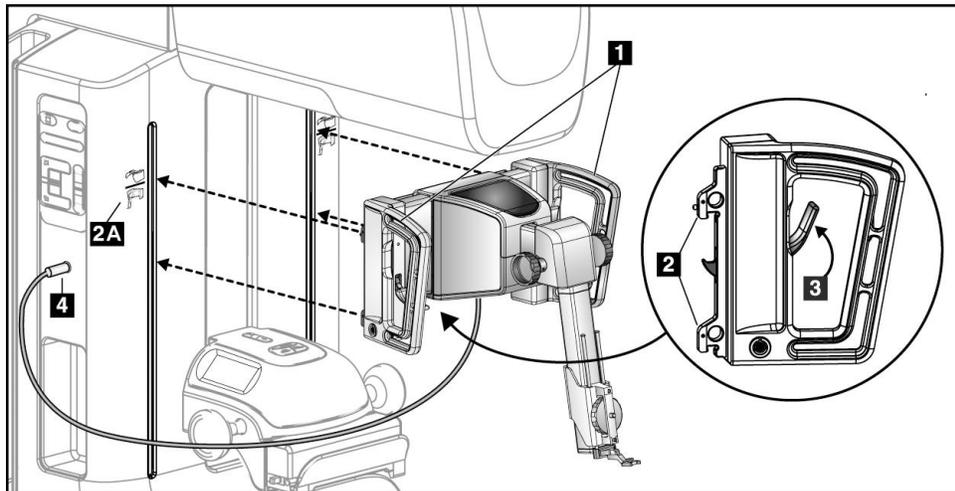
Figura 8: Instalación del módulo de guía de biopsia
