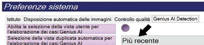
Figura 96: Selezione automatica per l'elaborazione dei casi Genius AI
