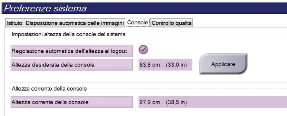
Figura 93: Campi Altezza desiderata della console e Altezza corrente della console
