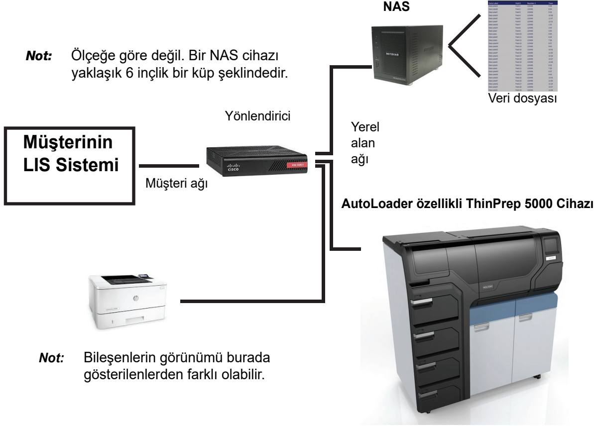
Şekil 2-2 Yerel Ağ Ara Bağlantı Şeması (Örnek)
