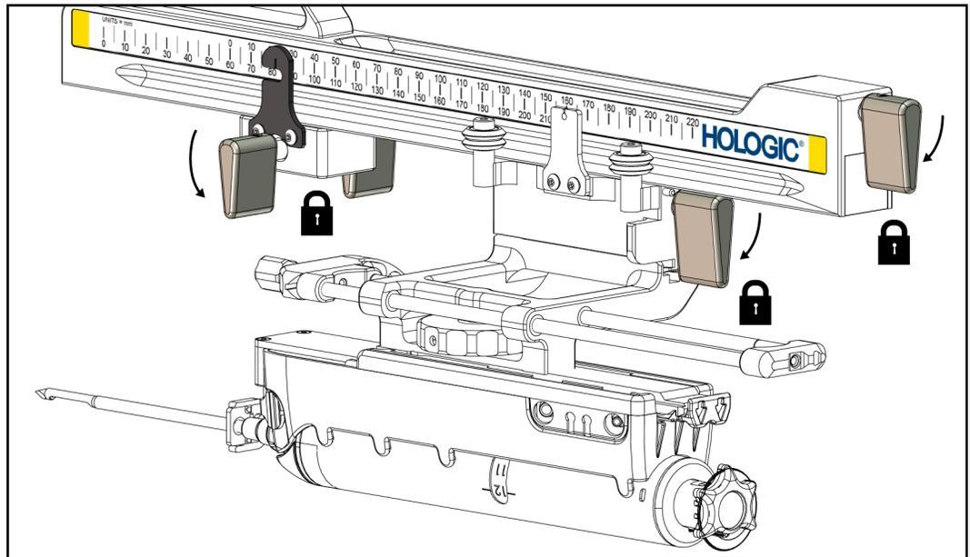
Figura 27: Palancas de bloqueo en posición totalmente bloqueada
