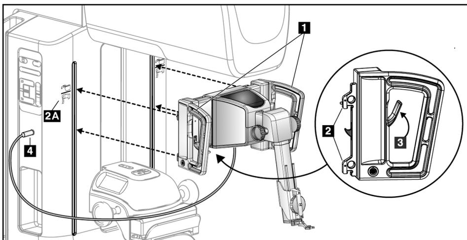
Figura 8: Installazione del modulo di guida per biopsia
