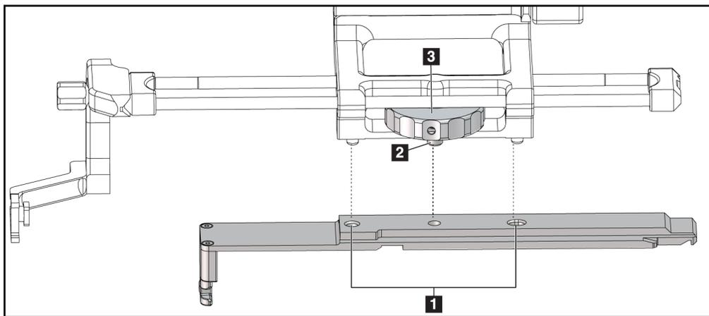
Abbildung 26: Befestigung des Biopsiegeräteadapters an der Gerätehalterung (Seitenarm)
