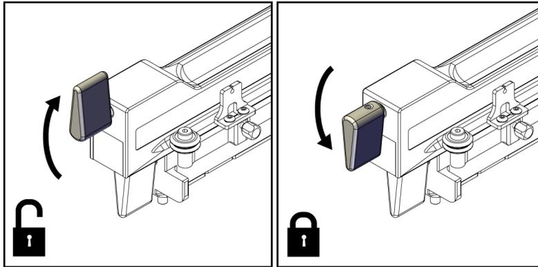
Abbildung 23: Verriegelte und entriegelte Position des Wagenhebels
