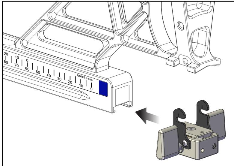
Abbildung 29: Installation des X-Stopps auf dem Seitenarm
