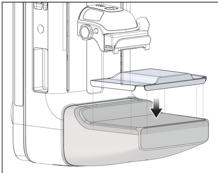
Abbildung 16: Installation des Seitenarmstativs über dem Bildempfänger
