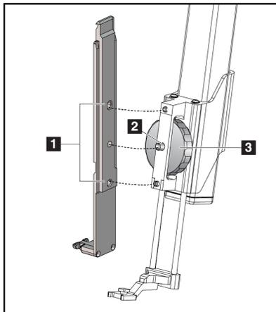
Abbildung 12: Befestigung eines Biopsiegeräteadapters an der Gerätehalterung (Standard)
