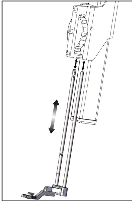
Abbildung 10: Installation des Nadelführungs-Halters auf der Standard-Gerätehalterung
