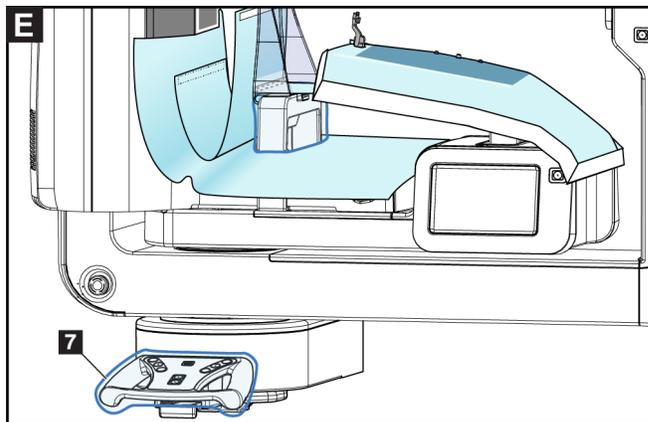
11. Para utilizar el abordaje de aguja lateral, el paño del soporte del dispositivo para biopsias se puede dividir en dos secciones. Separe el paño en la perforación que está entre el dispositivo para biopsias y la paleta (elemento 8).
