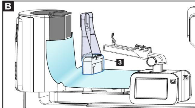
5. Coloque el paño correspondiente sobre el soporte del dispositivo para biopsias (elemento 4). Asegúrese de que la base de la guía de aguja y las tres protuberancias del dispositivo para biopsias estén alineadas con las respectivas aberturas del paño.
