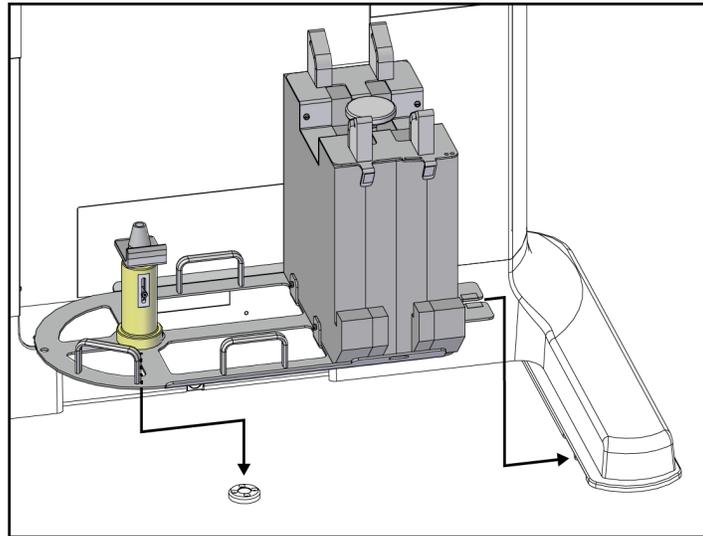
Figura 85: Ajuste el soporte del brazo del colimador
