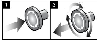
Figura 14: Funcionalidad de interruptor de apagado de emergencia
