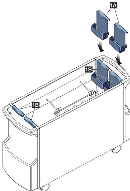
Figura 65: Instalación de los soportes para palas
