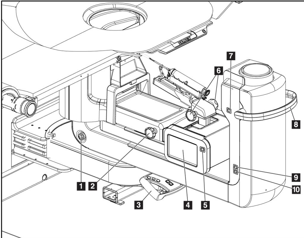
*Figura 6: Controles y pantallas del brazo del colimador*
