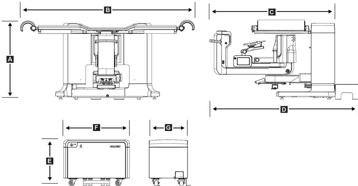
Figura 82: Medidas del gantry y el generador
