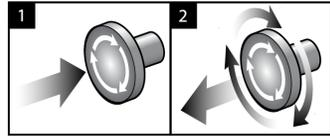
Figura 3: Funcionalidad de interruptor de apagado de emergencia
