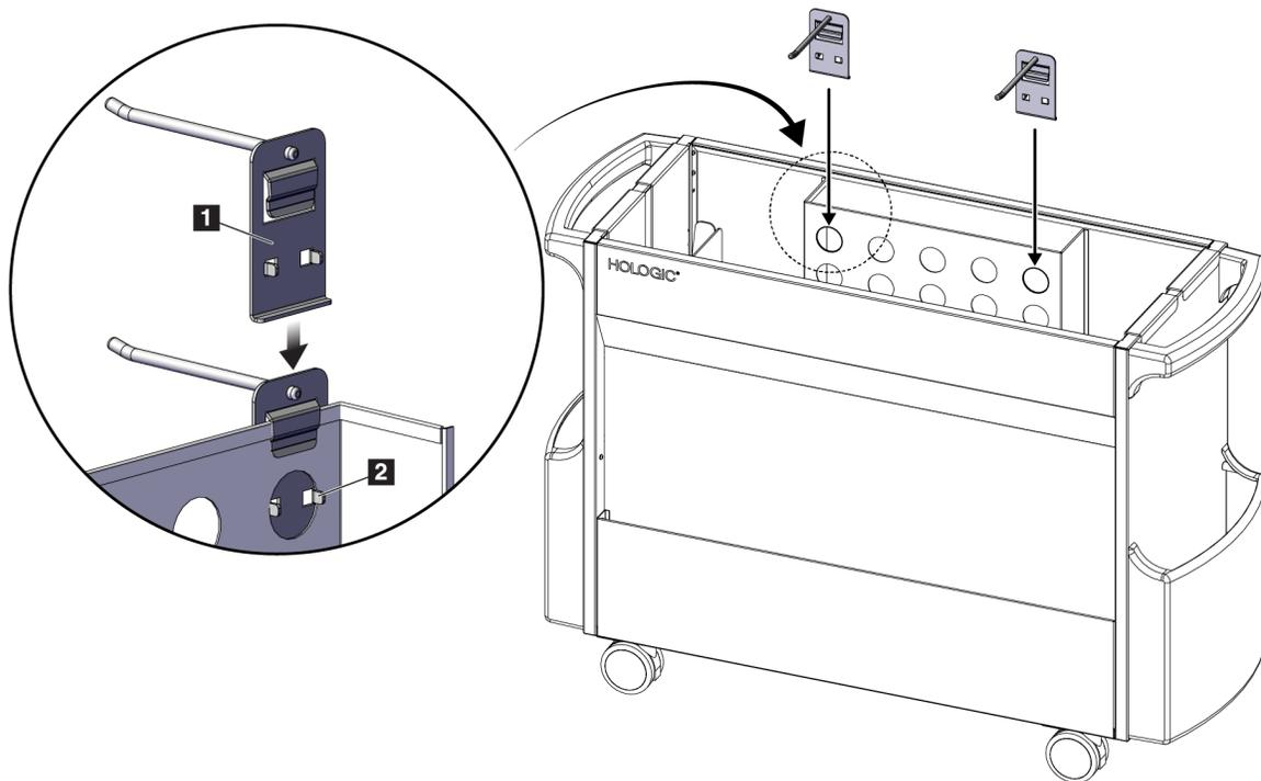
Figura 64: Instalación de los colgadores para almohadillas
