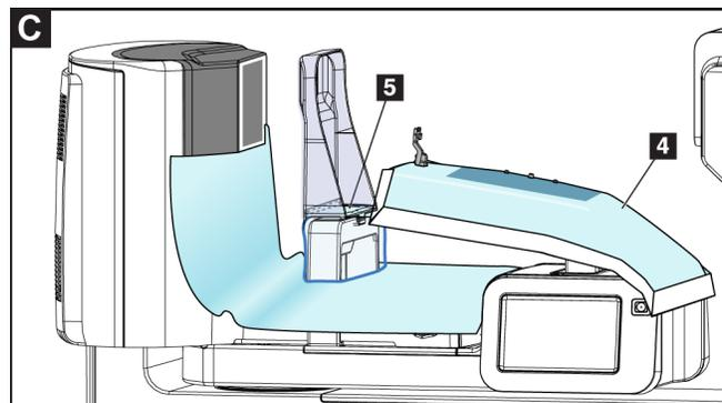
6. Quite la capa adhesiva que se encuentra debajo del lado de la pala del trozo de paño. Fije el borde del paño al borde interior de la pala a lo largo del lado del soporte de la pala (elemento 5).
