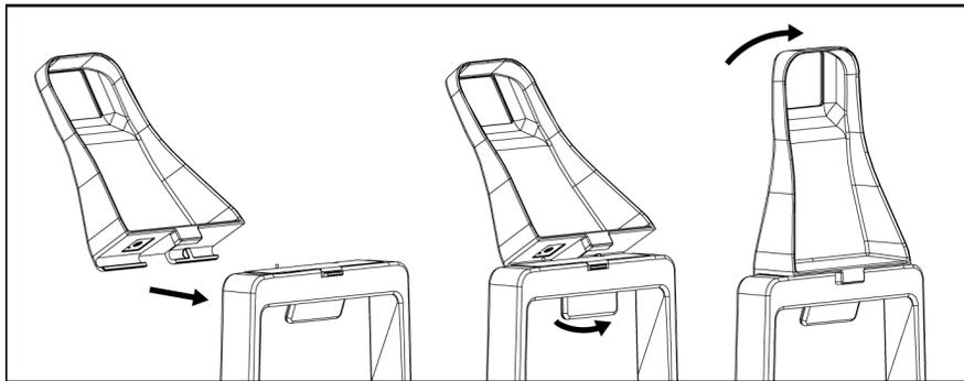
Figura 60: Instalación de la pala de compresión
