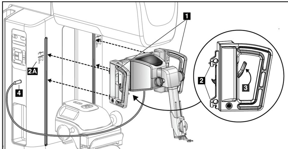
Figura 7: Instalación del módulo de guía de biopsia
