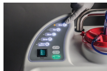
Alegeți „SET UP” (CONFIGURARE) și indicatorul luminos „VACUUM READY” (VID PREGĂTIT) va ilumina în verde continuu atunci când se realizează un vid adecvat. (În acest moment, verificați prezența soluției saline în filtrul de țesut și în orificiul acului).
