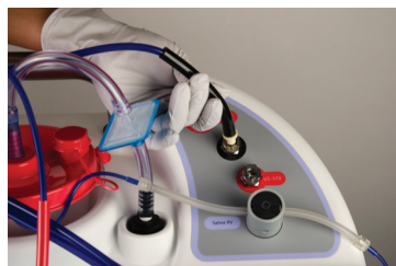
Conectați linia neagră a piesei de mână la receptaculul negru al piesei de mână situat pe interfața cu utilizatorul.
