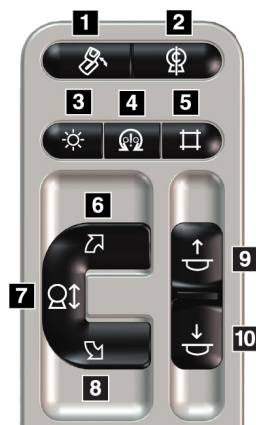
Figura 10: Panel de control del brazo del colimador
