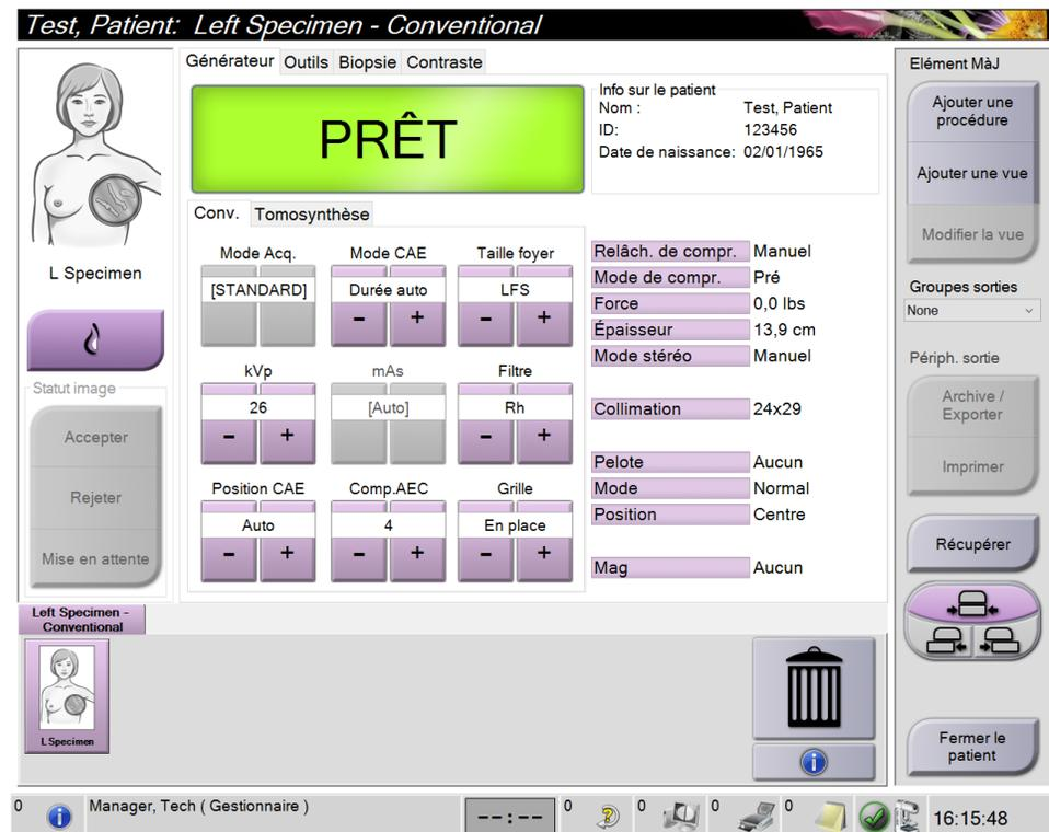
Figure 64 : Écran Procédure pour les échantillons
