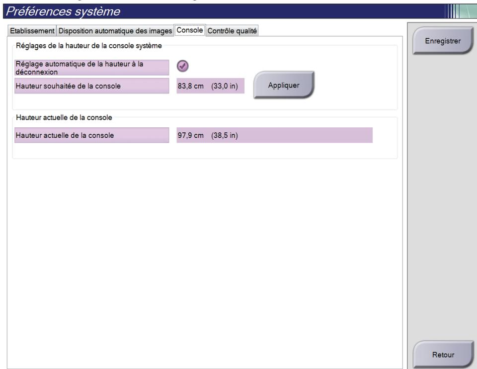
Figure 93 : Onglet Console de l'écran Préférences système
