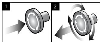
Figure 24 : Fonctionnalité du bouton d'arrêt d'urgence
