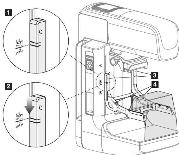
Figure 74 : Installation de la plaque d'agrandissement
