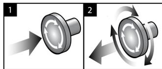
Figure 4 : Fonctionnalité du bouton d'arrêt d'urgence
