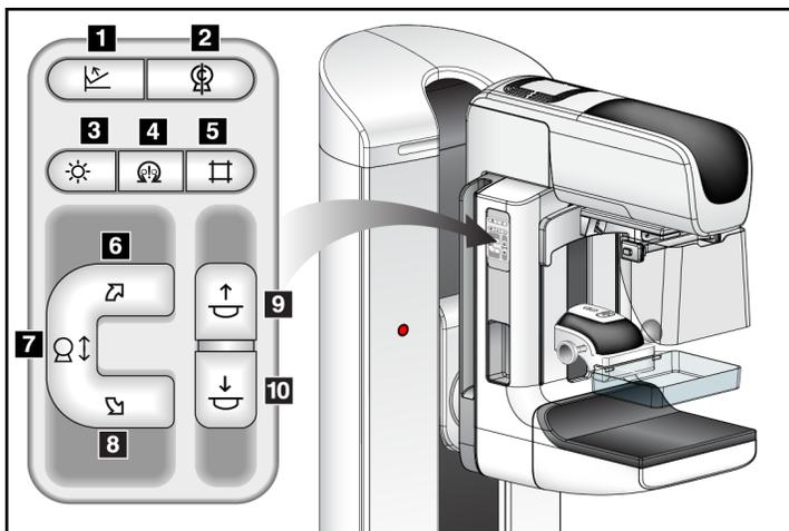
Figure 23 : Panneau de commande du bras en C
