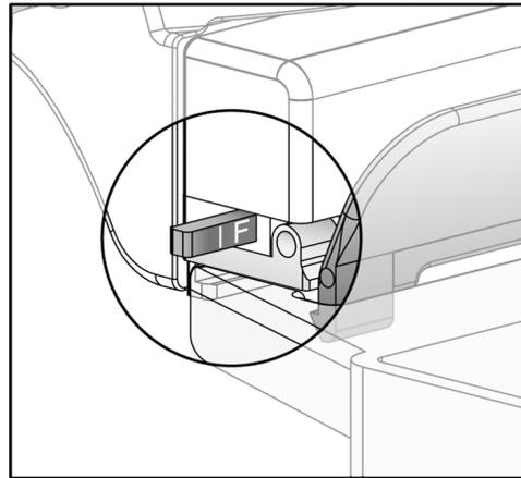
*Figure 73 : Bouton coulissant du mode de compression FAST*
