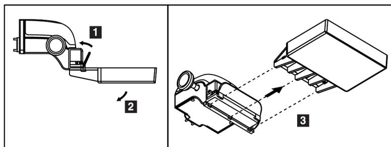
Figure 72 : Pour retirer une pelote de compression
