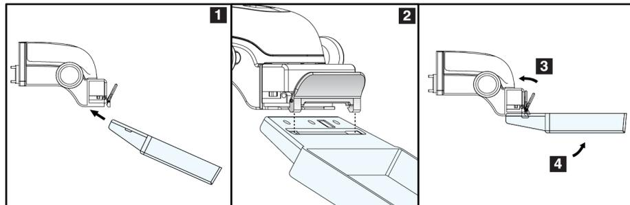
Figure 71 : Pour installer une pelote de compression
