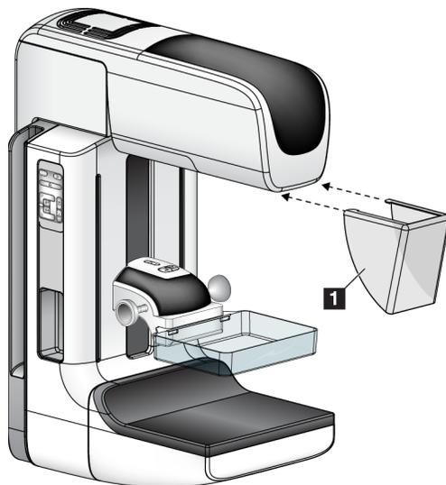
*Figure 70 : Installation de l'écran facial conventionnel*
