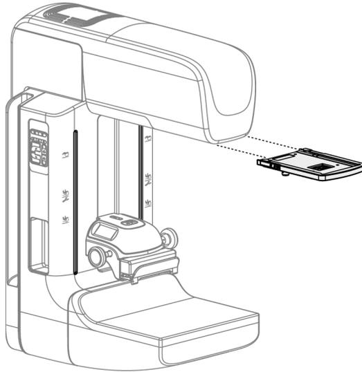
Abbildung 76: So installieren und entfernen Sie die Vergrößerungs-Fadenkreuzvorrichtung
