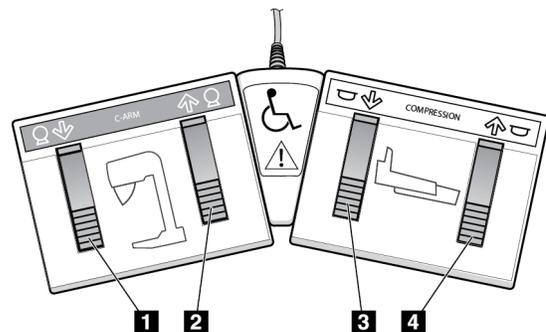
Abbildung 12: Zweifunktions-Fußschalter
