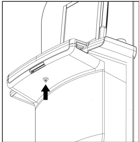
Abbildung 113: Tastaturfach-Verriegelungsknopf (Premium-Workstation)
