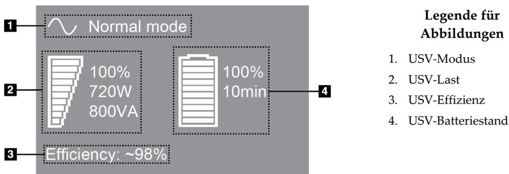
Abbildung 111: USV LCD-Display
