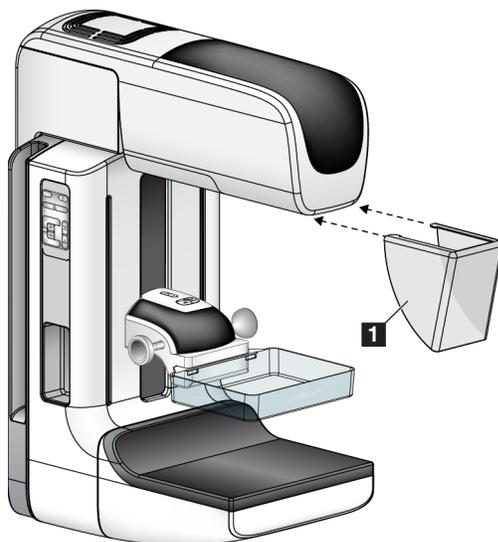
Figura 70: Modalità di installazione dello schermo facciale convenzionale
