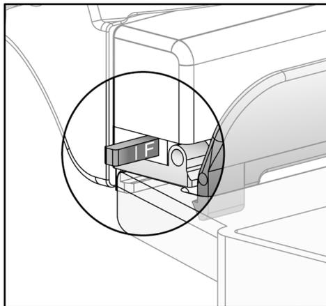
Figura 73: Cursore della modalità di compressione FAST
