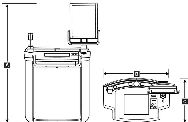
Figura 110: Misure della stazione di acquisizione mobile Premium
