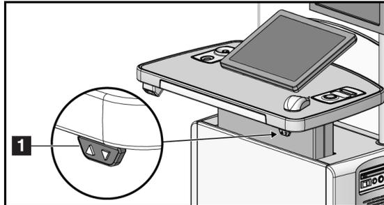
Figura 94: Pannello di controllo della regolazione in altezza
