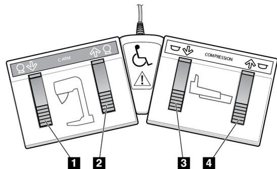
Figura 12: Interruttore a pedale a doppia funzione
