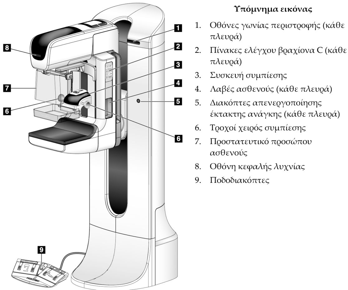
Εικόνα 6: Στοιχεία ελέγχου και ενδείξεις βάσης λυχνίας
