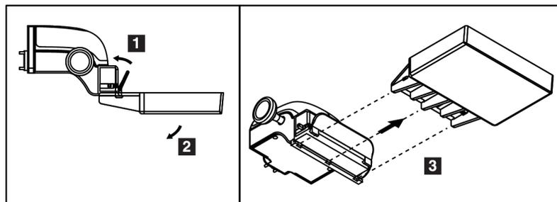
Figura 73: Cómo extraer una pala de compresión
