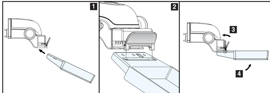
Figura 72: Instalación de una pala de compresión
