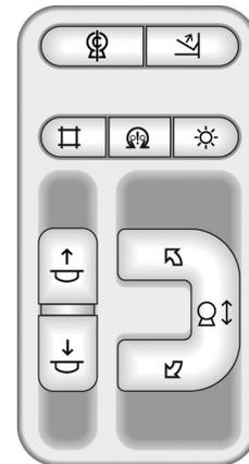
Figura 10: Panel de control del brazo del colimador
