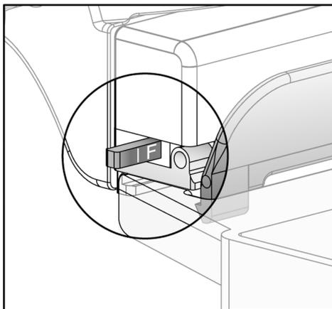
Figura 74: Control deslizante del modo de compresión FAST
