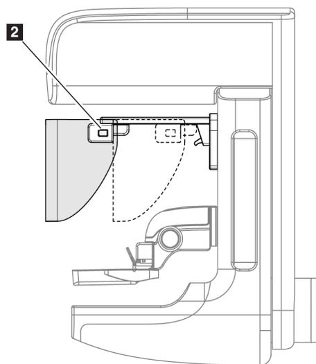
Figura 66: Funzionamento dello schermo facciale
