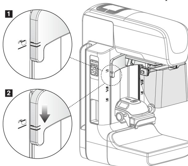
Figura 64: Allineamento dello schermo facciale retrattile sul braccio a C
