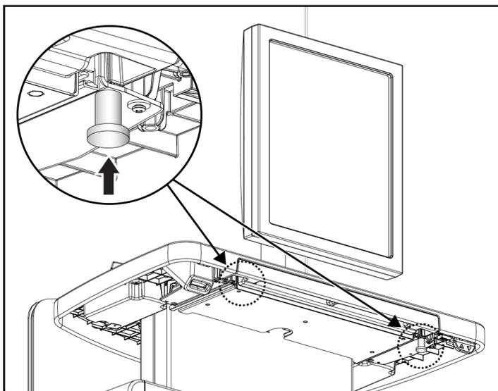
Figura 109: Manopola di blocco del portatastiera, lato destro o sinistro (stazione di acquisizione universale)
